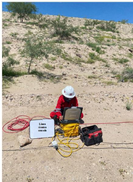
Figura 4.2: Operación de consola en la adquisición de datos en campo para refracción sísmica
