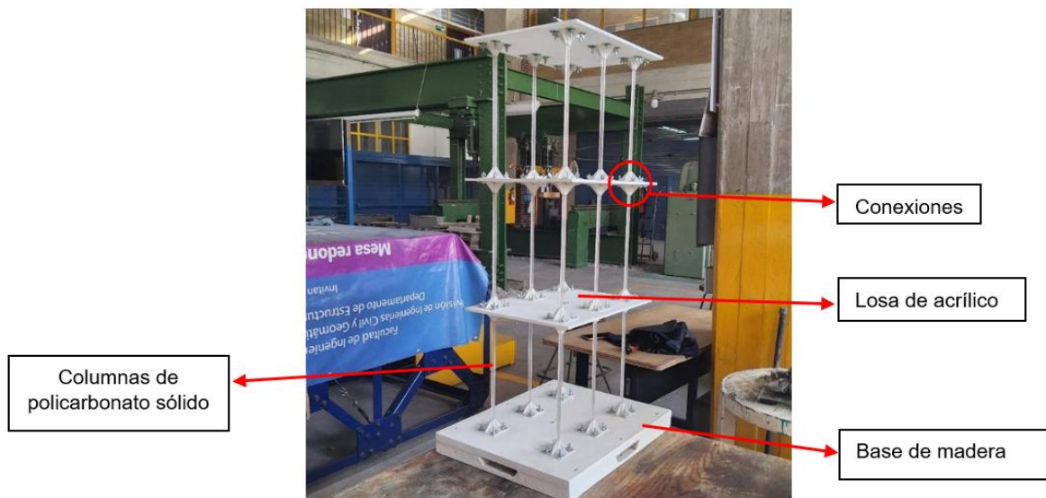
Figura 3.2. Modelo físico de referencia (Modelo 0).
