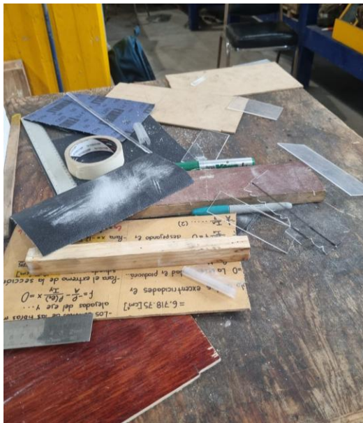
Figura A1.2. Corte de paredes de acrílico para los modelos físicos.
