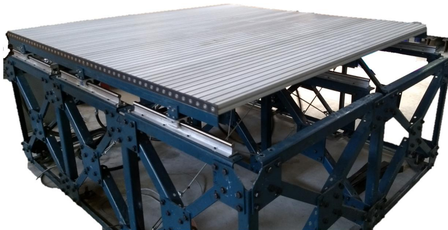
Figura 3.1. Estructura de la mesa vibradora.
