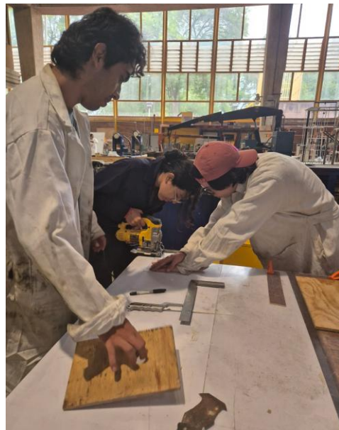
Figura A1.2. Corte de paredes de acrílico para los modelos físicos.
