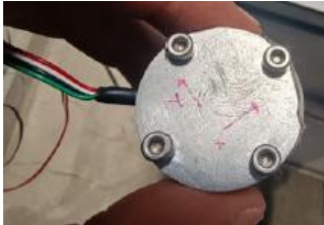
Figura 4.3. Acelerómetro tipo MEM modelo ADXL-203.
