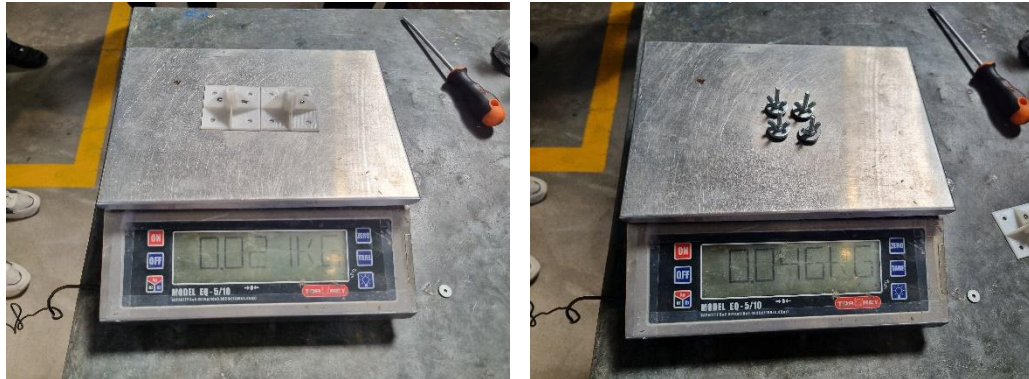
Figura 3.8. Peso de elementos de las conexiones.
