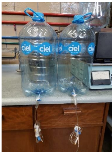
Figura 25. Sistema de goteo.
