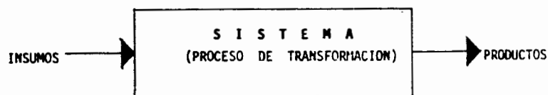
FIGURA 11. DIAGRAMA DE BLOQUES UTILIZADO EN LA CONCEPCIÓN DE CAJA NEGRA
