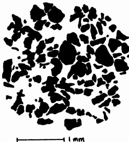
Figura 8.3, Siluetas de granos arenosos esqueléticos en contacto tridimensional. Preparada por esparcimiento sobre un medio fundido. Dibujada de la imagen de un microproyector ( Tomado de Bathurst, 1971,p.485).
