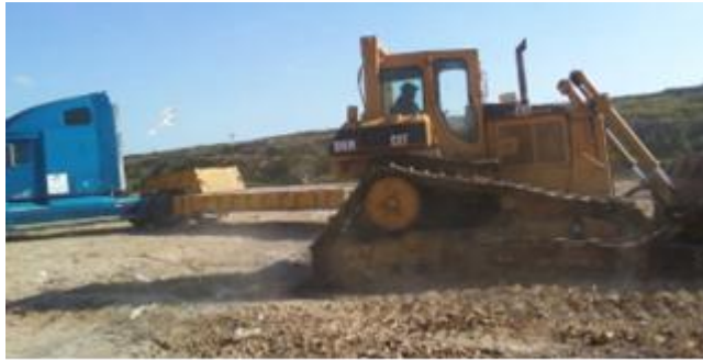
Imágenes 123 y 124. Fotografía de la izquierda, un tractor de orugas es entregado en el interior de las instalaciones del relleno sanitario para apoyar en las actividades de limpieza y saneamiento. Fotografía de la derecha, el mismo tractor de orugas realizando la conformación y compactación de residuos en una de las celdas con residuos expuestos al aire libre. Imágenes cortesía del Ing. Magdaleno Rodríguez.
