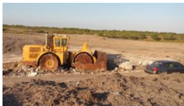
Imagen 114. Fotografía de la izquierda. Compactador de residuos conocido coloquialmente como “pata de cabra” siendo examinado para determinar la factibilidad de su reparación.
