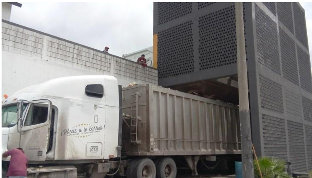
Imagen 108. En la parte superior de la fotografía se aprecia la caja de un camión compactador que transfiere sus residuos al tractocamión en la Estación de Transferencia “12 de marzo”. El tractocamión recibe los residuos de cuatro camiones compactadores y una vez lleno, sale de la Estación de Transferencia con destino al Relleno Sanitario Regional.
