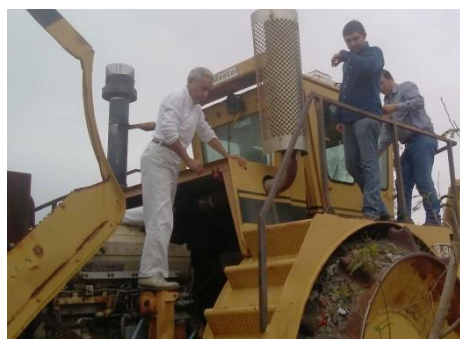
Imagen 114. Fotografía de la izquierda. Compactador de residuos conocido coloquialmente como “pata de cabra” siendo examinado para determinar la factibilidad de su reparación.
