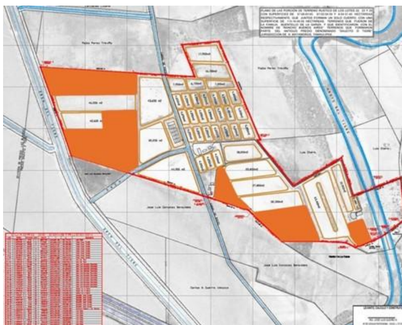
Imagen 118. Plano del Relleno Sanitario Regional de Matamoros con las áreas con residuos expuestos al aire libre indicadas en color naranja. La mayor parte de los residuos se encontraban calcinados por el fuego Imagen propia elaborada con información obtenida de los recorridos en campo.
