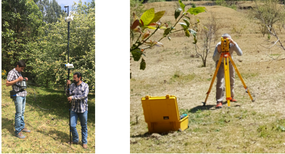
Figura 4.2: Levantamientos realizados para ubicar la estación magnetotelúrica. Derecha: Levantamiento de datos magnéticos. Izquierda: Medición de campo magnético absoluto.
