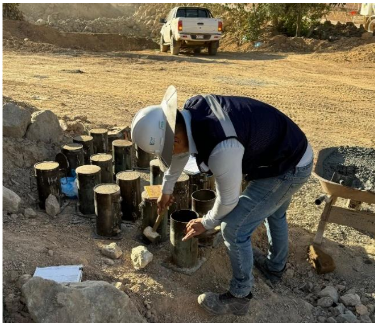
Figura 4.3 Vibrado de la muestra de concreto con martillo de goma
