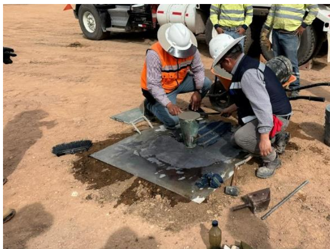
Figura 4.10 Prueba de extensibilidad
