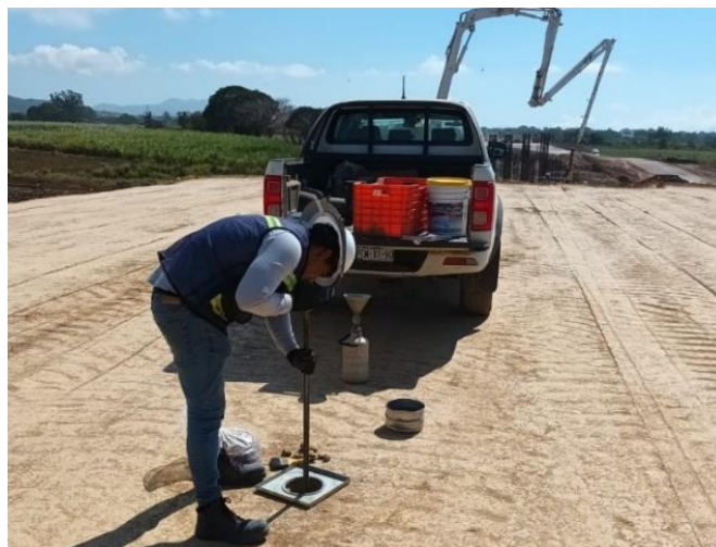
Figura 4.13 Excavación para la prueba de compactación
