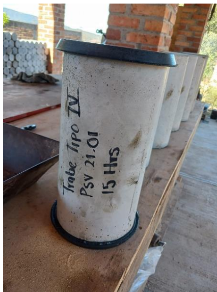
Figura 4.6 Cabeceó de especímenes
