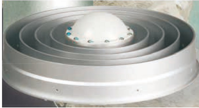
Figura 4.3: Anillos de Ahogo (Choke Rings) de la antena CR3 G3
