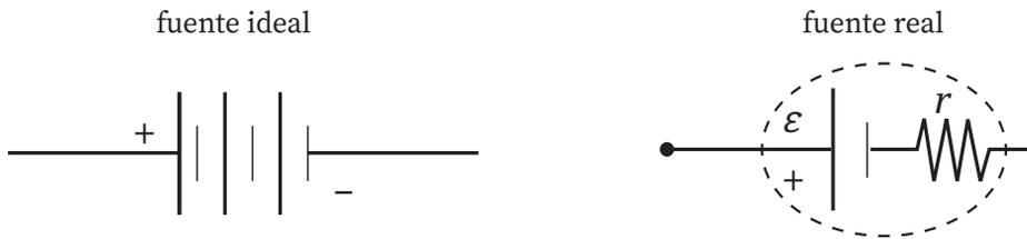
**Figura 4.31.** Diagramas de una fem ideal y una real
