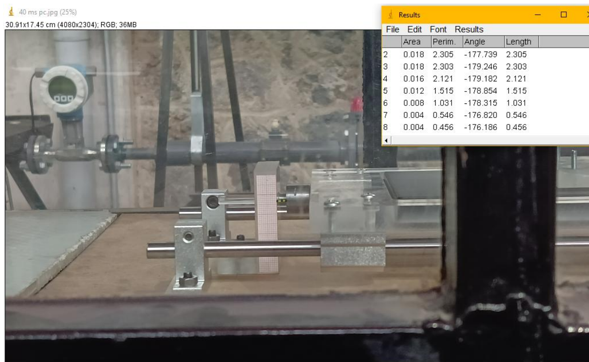
Figura E.1. Banco de pruebas con vehículo Dinalpin colocado dentro del túnel de viento.
