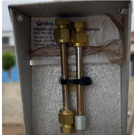
Figura 2.1: Ejemplo de muestreo pasivo. 1
