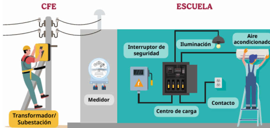
Figura 5.7 Esquema Eléctrico Escuelas
