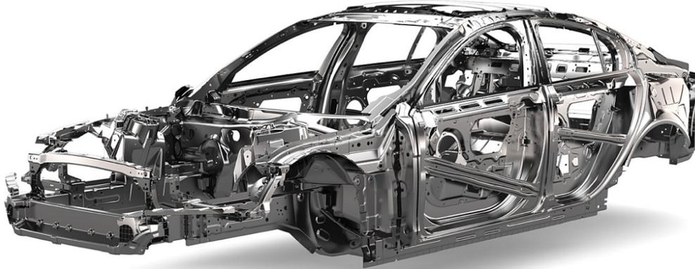
*Figura 3. Ejemplo del Body in White de un vehículo. (Sacha Engineering)*
