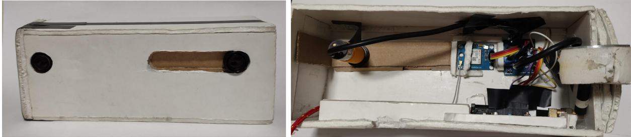
Figura 6.8: Fotografías del Dispositivo. Distancia entre infrarrojos ajustable.
