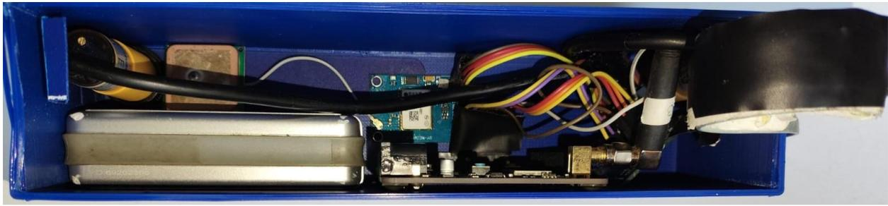
Figura 6.18: Carcasa impresa en 3D. Vista trasera de componentes internos.
