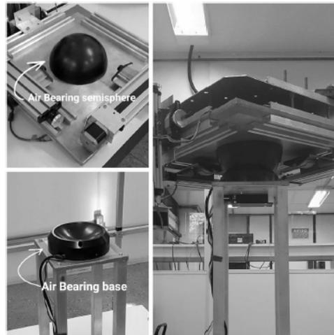
**Figura 3.3:** Ensamble de plataforma de aire. [28]
