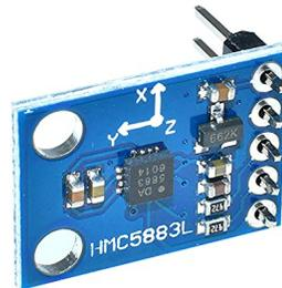
**Figura 4.23:** Magnetómetro HMC5883L.
