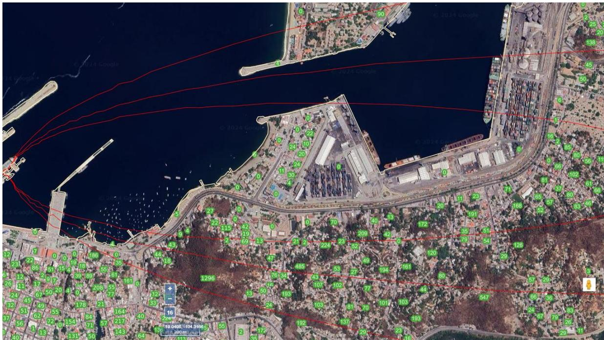
**Figura 4.3.** Población afectada en caso de formación de nube de vapor tóxico.
