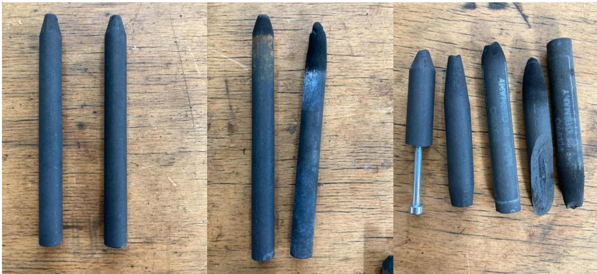
Figura 4. Electrodos de carbono utilizados (incluidas pruebas de durabilidad, ductilidad y resistencia).
