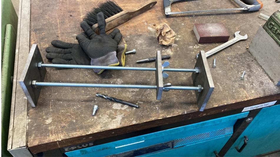
Figura 16a. Prototipo de la pinza de sujeción de la cámara hiperbárica.
