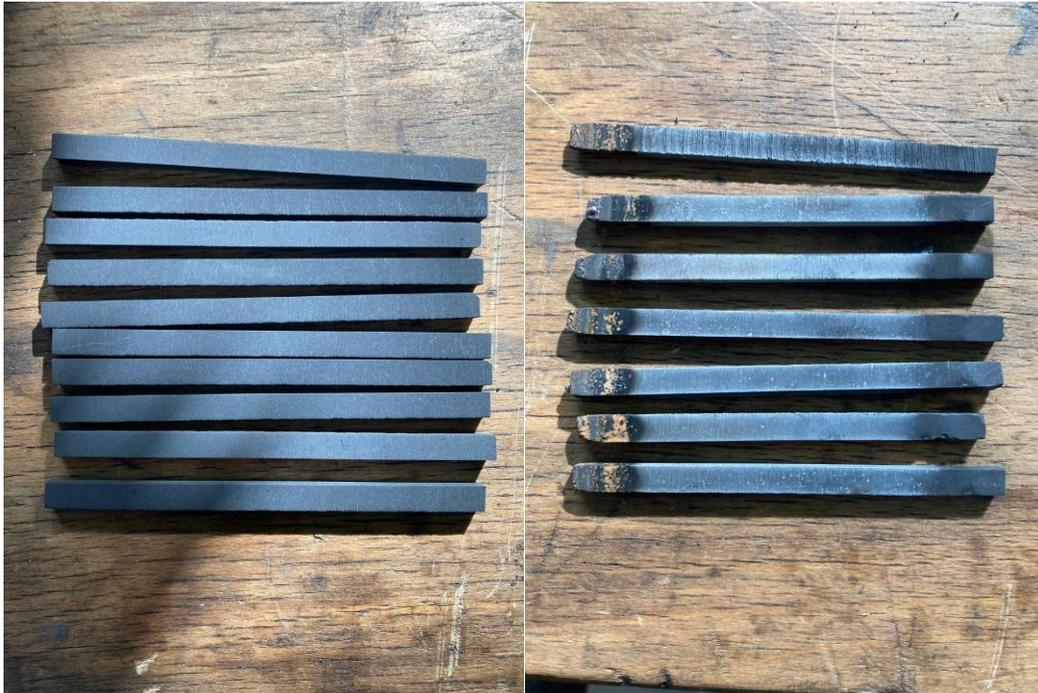
Figura 5. Prueba de durabilidad de electrodos de carbono de distintas geometrías.
