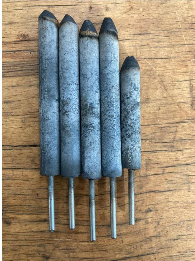
Figura 14. Electrodo de carbono modificado y adaptado al banco de pruebas.
