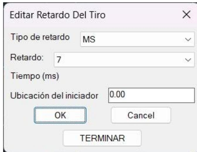
*Ilustración 63. Ventana de configuración de retardos para barrenos.*
