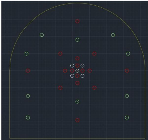
*Ilustración 49. Marcaje de barrenos en AutoCAD*
