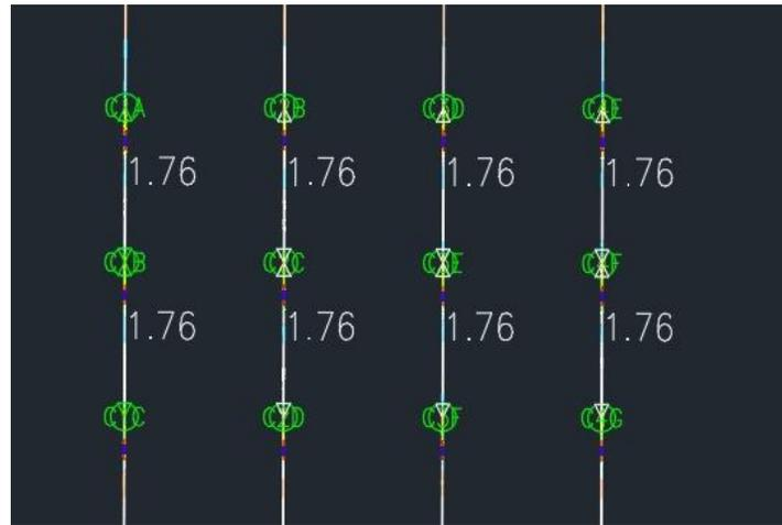
Ilustración 124. Plantilla de barrenos paralelos vista desde planta.
