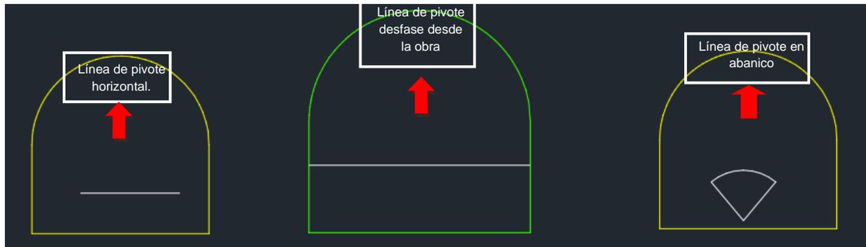
Ilustración 11. Línea de pivote horizontal y en abanico.
