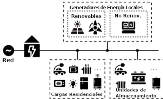
Figura 2.5 Diagrama de un sistema de microgeneración (Ortiz y col., 2021)
