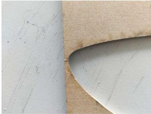
3. Debido a desviaciones en la manufactura, se realizó un lijado para que la sección del ala encajara con mayor precisión.
