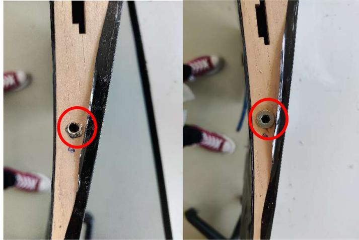
14. Con el fin de evitar que la superficie de control vibrara durante el experimento, se añadió plastilina en la bisagra, cuidando no añadir una cantidad de masa que pudiera llegar a repercutir en los resultados. Esto dio una mayor rigidez a toda la estructura.
