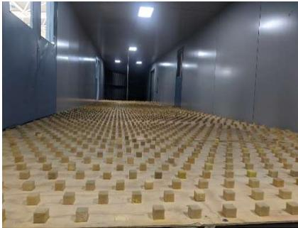
Figura 25. Arreglo típico de sección de pruebas típico en el túnel de viento Fiidem-IIUNAM.
