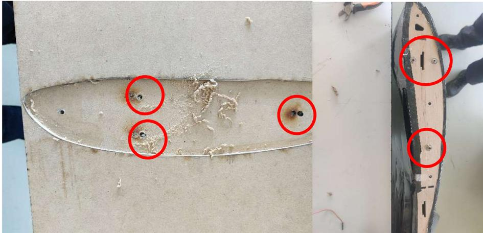
12. Debido a un error de orientación al momento del pegado, se tuvieron que realizar los barrenos nuevamente en las ubicaciones donde irían los tornillos. Esto se llevó a cabo con la ayuda de una broca sierras "sacabocados" únicamente sobre las dos tablas inferiores.
