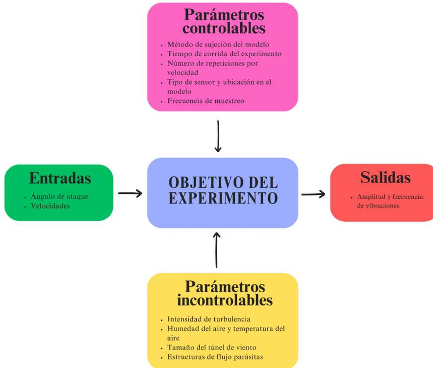
Figura 46. Diagrama de bloques del experimento.
