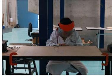
20. Se realizó el pegado de los chaflanes realizados en manufactura aditiva en bloques de dos. Para evitar que se adhirieran a las superficies, se utilizó cinta adhesiva en cada unión, y se procedió a utilizarse gotas de super pegamento aplicadas desde la parte superior. Por las razones mencionadas en el paso 16, fue necesario seguir el siguiente arreglo de bloques:
