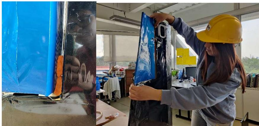
15. Con el propósito de lograr una geometría aerodinámica lo más parecida posible a la simulada en CFD, se procedió a añadir Monokote® con ayuda de una plancha caliente sobre el espacio de la bisagra y la superficie de control, así como en cualquier imperfección o desgaste del skin de la estructura.
