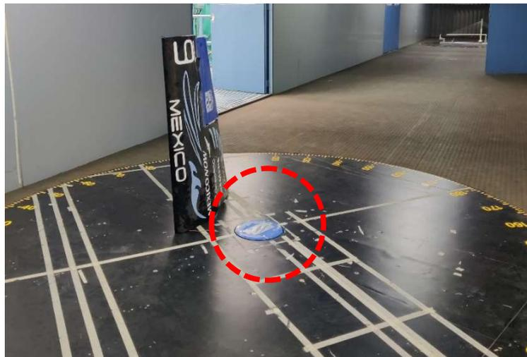
Figura 52. Protuberancia en mesa giratoria del laboratorio de túnel de viento Fiidem-Instituto de ingeniería UNAM (IIUNAM).
