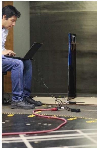
10. Hacer que baje el receptor para poderse conectar a la unidad de cómputo. Una vez hecho esto, configurar el sensor de acuerdo a la frecuencia de muestreo máxima de 250 [Hz].
