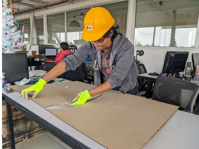
6. Dado que el CAD no considera el tapeo del borde de salida, se realizó un corte con cutter siguiendo al máximo posible el contorno marcado y se lijó hasta ajustar.
