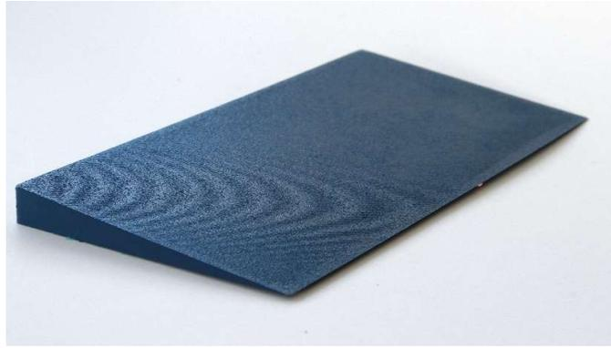
18. Para ofrecer un acabado en el borde que permitiera la adhesión con los chaflanes de PLA, se procedió a realizarse un lijado de esta cara. Primeramente, con ayuda de prensas, se sujetaron las tablas por las esquinas a una mesa para una mayor comodidad al momento de realizarse.
