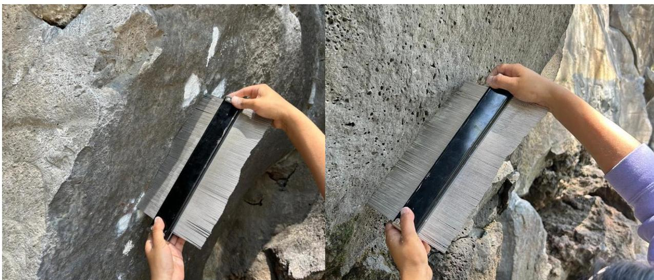
Figura 4.2. Obtención de perfiles de rugosidad mediante el uso del peine de Barton en las zonas de validación escogidas para su uso en este trabajo.
