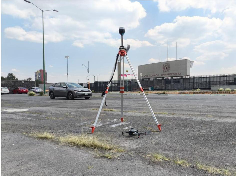
Figura 4.3. Antena RTK REACH RS2+ durante el proceso de corrección de coordenadas dentro de las instalaciones del estadio olímpico universitario.
