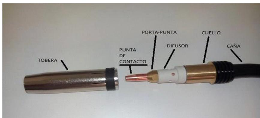
**Figura 1.24** Tobera y boquillas del proceso MIG. (<https://www.lacorformacion.com/blog/soldadura-mig-mag-la-antorcha>)
