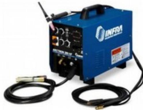
FIGURA 3.4 Máquina para el proceso TIG.
