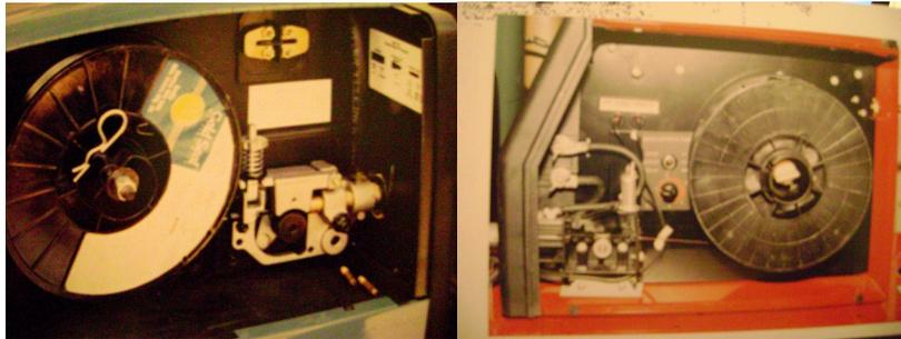
*Figura 5. Mecanismo interior de una maquina MIG.*
