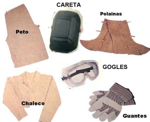
*Figura 10. Equipo de protección para soldadura*
