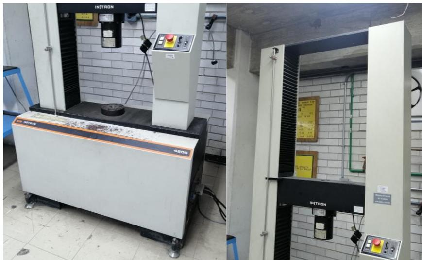
Figura 37. Izquierda: base de la máquina, mesa de trabajo, columnas y panel de control. Derecha: viga superior y cabezal móvil con la celda de carga.
