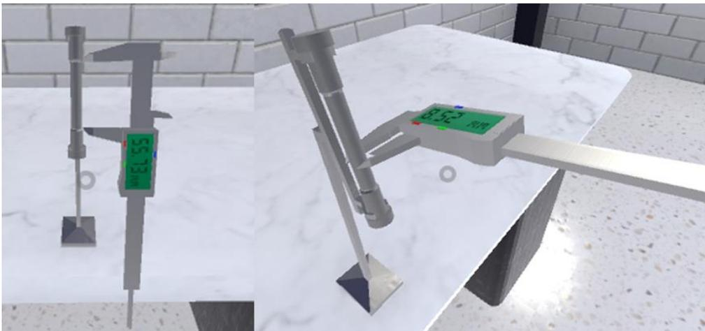
*Figura 95. Mediciones iniciales con el vernier.*
