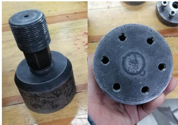
Figura 5. Izquierda: base atornillable. Derecha: barrenos de la base.
