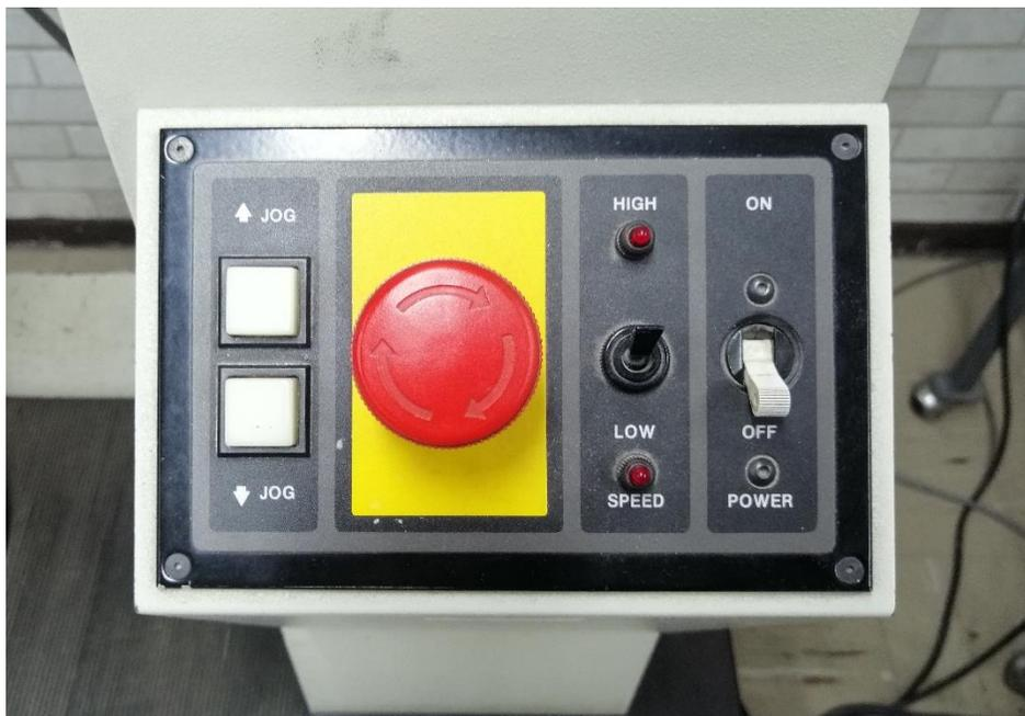
*Figura 49. Panel de control de la máquina universal de ensayos.*
