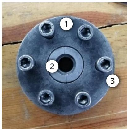
Figura 6. 1: Mordaza. 2: Anillo metálico. 3: Uno de los seis tornillos.
