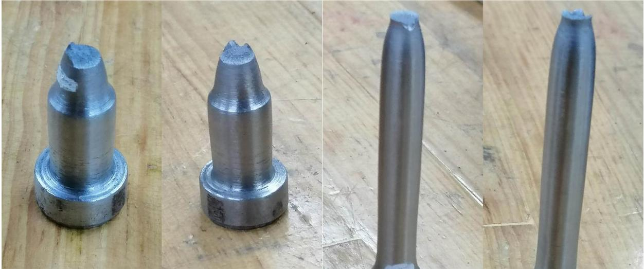
*Figura 90. Fractura de la probeta simplemente maquinada.*
