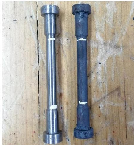
*Figura 3. Probetas usadas durante la visita al laboratorio. Del lado izquierdo se observa la probeta simplemente maquinada y, del lado derecho, la probeta maquinada y recocida.*
