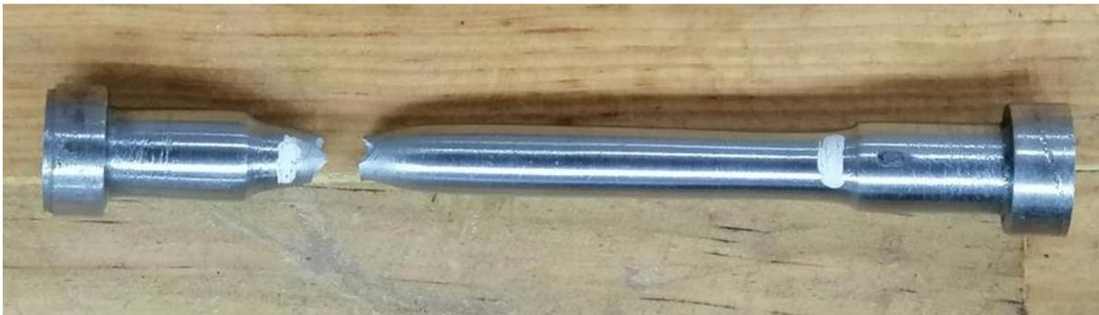
Figura 85. Probeta simplemente maquinada después del ensayo de tracción.
