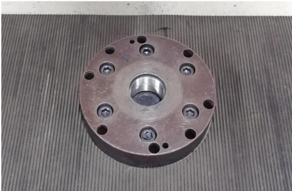
*Figura 41. Base fija para atornillar el herramienta.*
