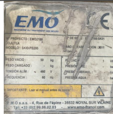
Figura 52. Datos de placa de filtro banda.
