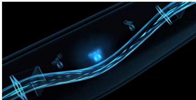
Figura 16. Bobina electromagnética del sensor encendida, sin flujo. 38
