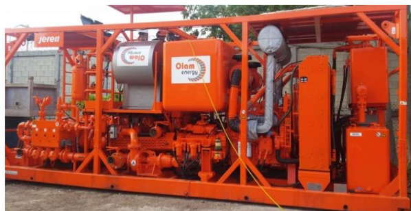
Figura 12. Unidad de alta presión (UAP). (Olam, energy, 2024)
