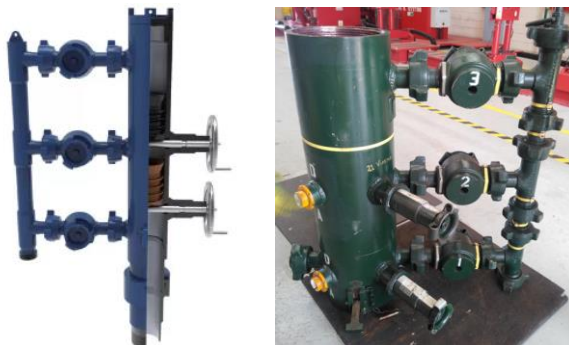
Figura 11. Cabeza de cementar (Puyang Zhongshi group Co., Ltd., 2024)
