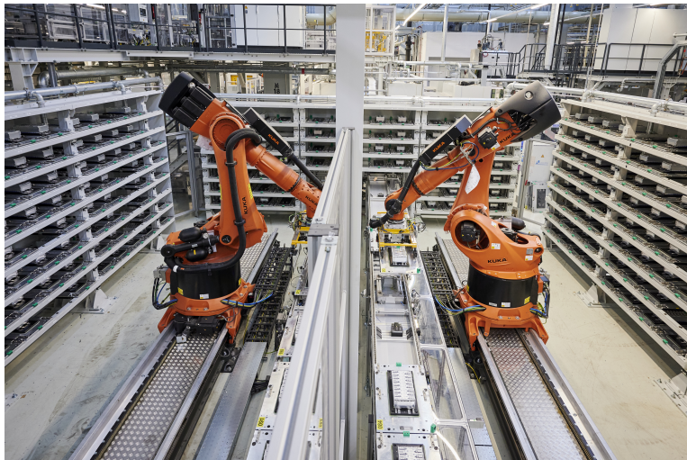
Figura 5.2 Estación de ensamblado de baterías eléctricas. 2
