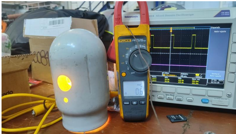
Figura 94 Prueba de corriente por medio de amperímetro de gancho y ciclo de trabajo aplicado a un foco incandescente mostrado en un osciloscopio
