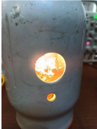
Figura 93 Prueba de intensidad de encendido de un foco incandescente controlado por una señal PWM con un porcentaje menor al 20%
