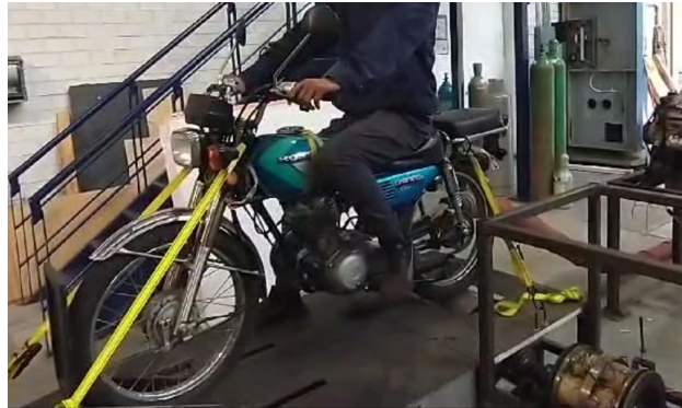
Figura 97 Prueba realizada en el dinamómetro de motocicletas del laboratorio UNICE con una moto honda de 125 cc
