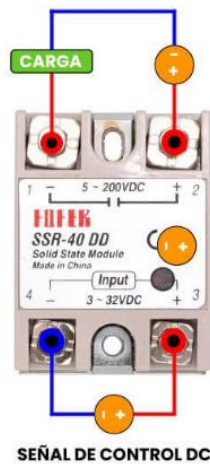
Figura 67 Diagrama de conexión para el relevador de estado sólido SSR-40 DD
