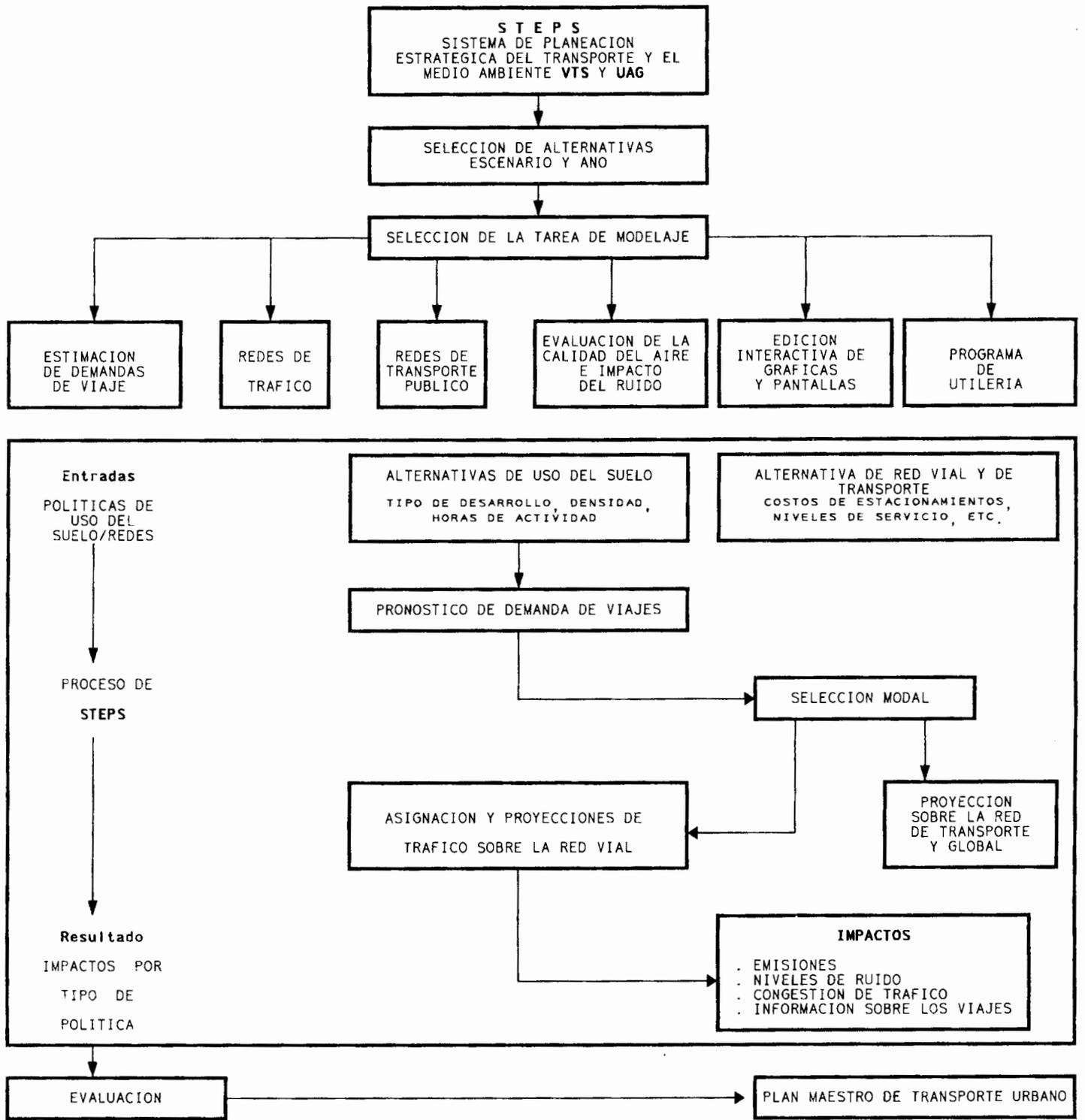
Figura 11.4 Esquema General del Sistema STEPS
