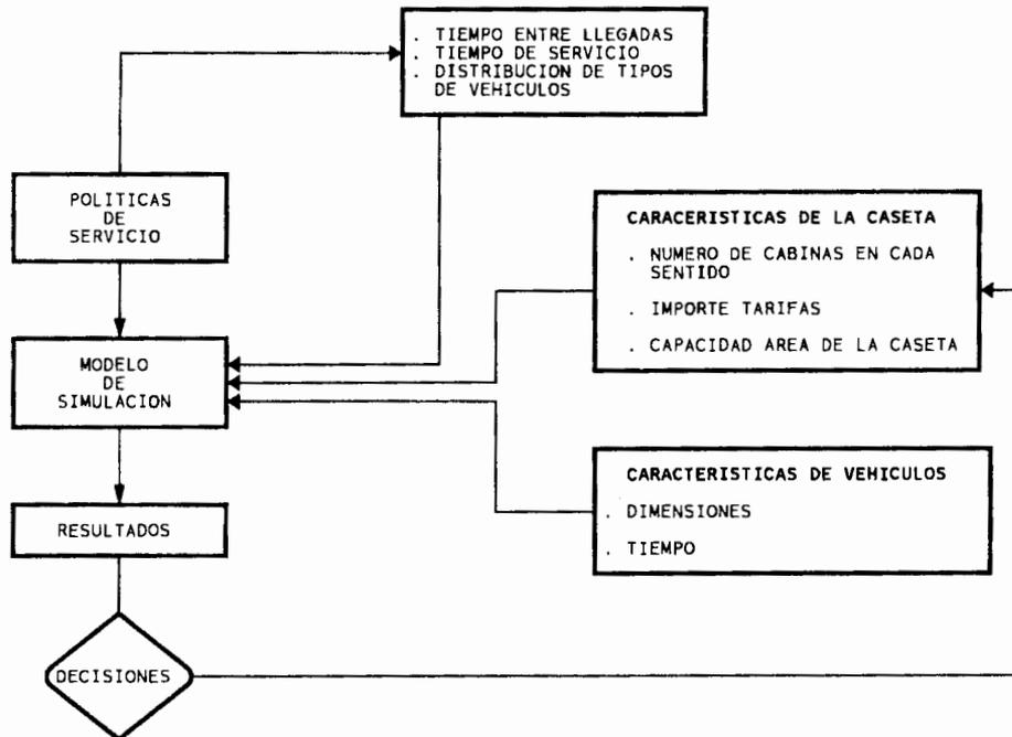
Esquema Conceptual del Modelo de Simulación de Casetas
