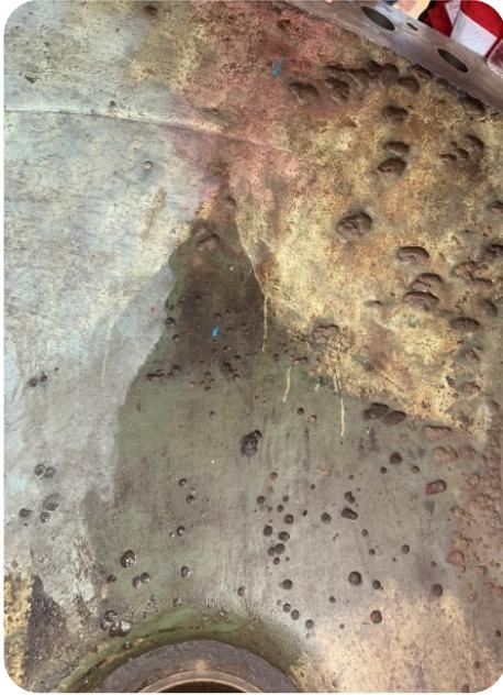
**FIGURA 1.8a** EFECTO DE LA CAVITACIÓN EN EL CUERPO DE UNA VÁLVULA ESFÉRICA
