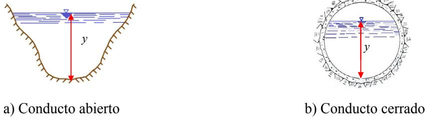
FIGURA 4.19 EJEMPLOS DE CONDUCTOS CON SUPERFICIE LIBRE
