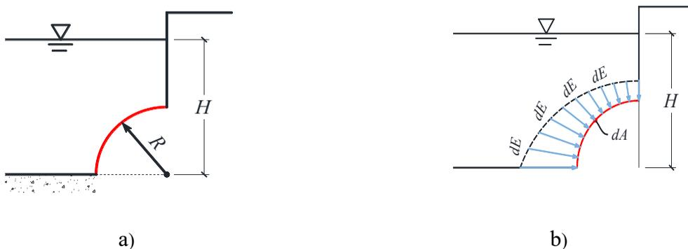
**FIGURA 2.20** a) SUPERFICIE CURVA. b) EMPUJES ELEMENTALES SOBRE UNA SUPERFICIE CURVA
