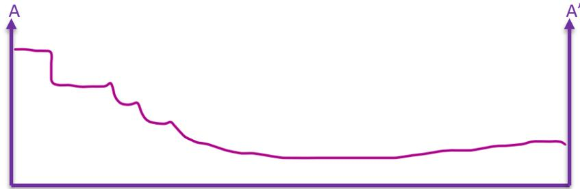
Figura 8. Esta imagen muestra la diferencia en la elevación superficial entre el 2013 y el 2014. Observa la pérdida de elevación en el área del escarpe principal y el aumento de elevación en la región del dedo (modificado de <http://gis.ess.washington.edu/areas/oso/>).
