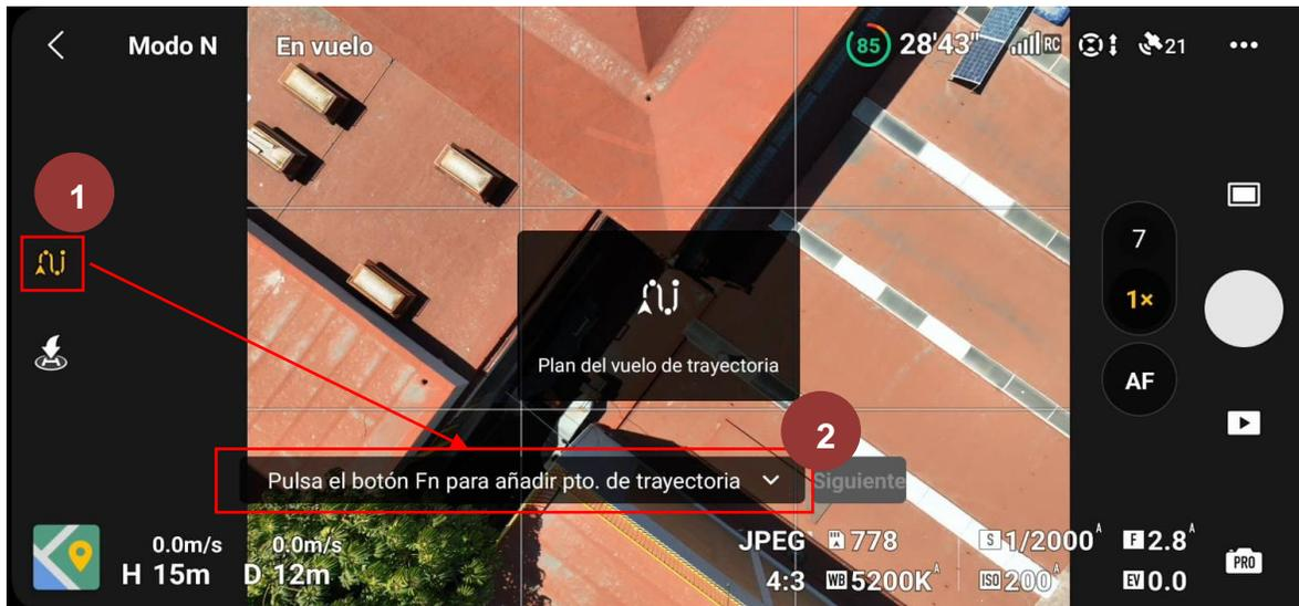
Figura 170. Plan del vuelo de trayectoria.
