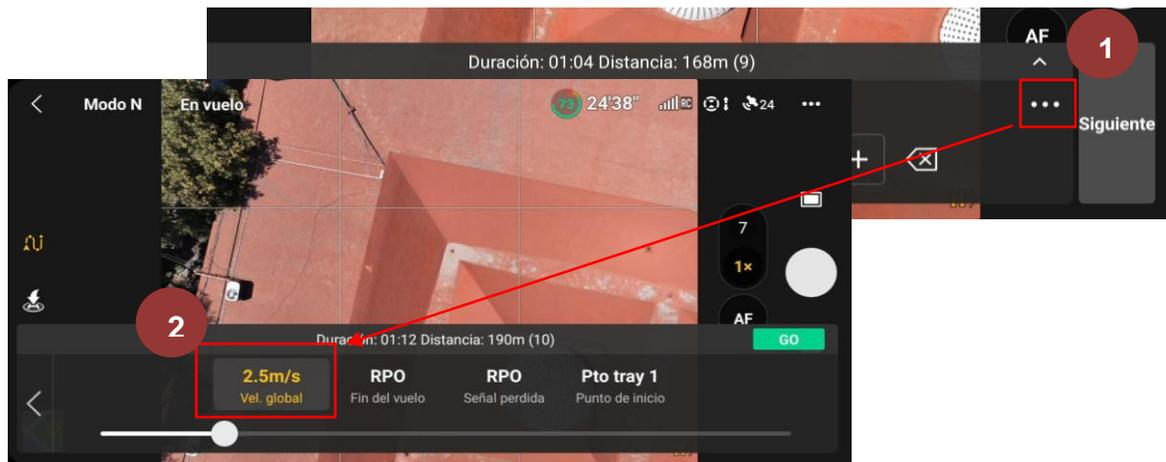
Figura 167. Ajuste de la velocidad del vuelo.
