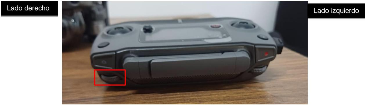
Figura 162. Dial de inclinación de la cámara.
