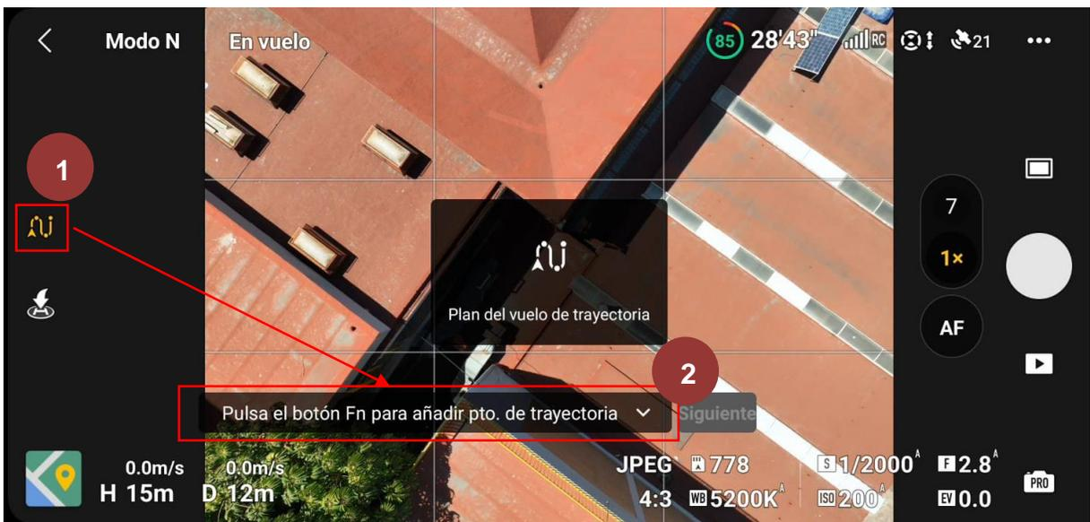
Figura 163. Plan del vuelo de trayectoria.
