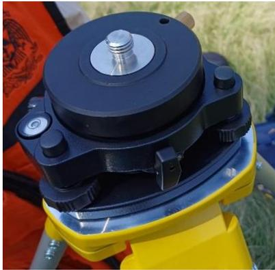
*Figura 14. Adaptador de precisión.*
