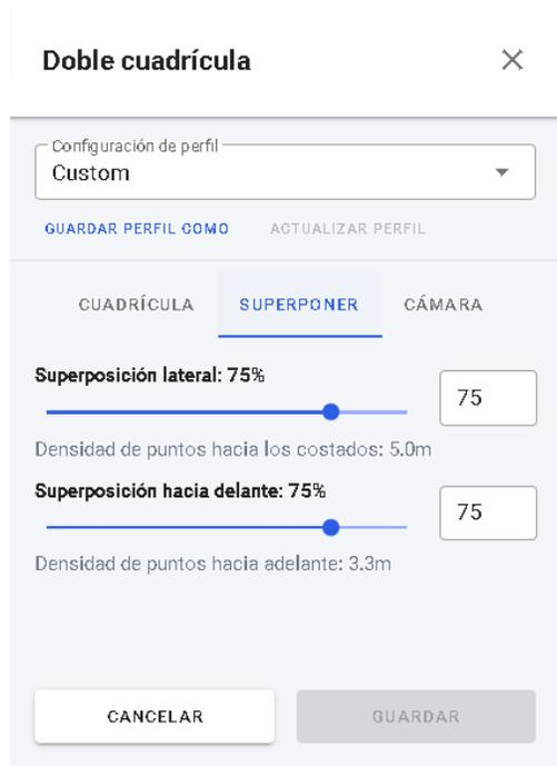
Figura 151. Configuración de la superposición de las fotografías.
