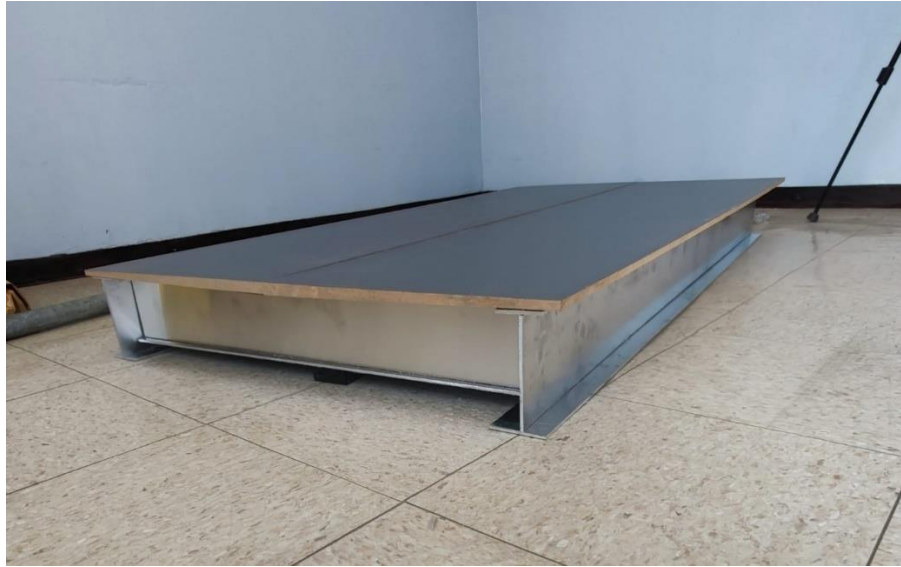
Figura 51. Tablero del puente Garra de Jaguar sin pantallas acústicas.
