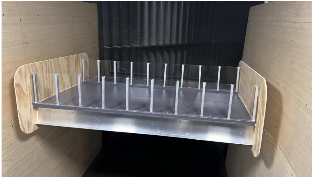
Figura 52. Tablero del puente Garra de Jaguar con pantallas acústicas.
