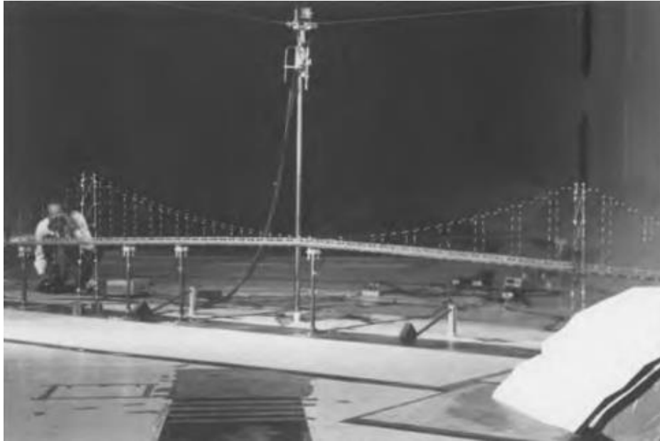
Figura 21. Modelo aeroelástico del puente Lions Gate, Vancouver (Larsen, 1992).
