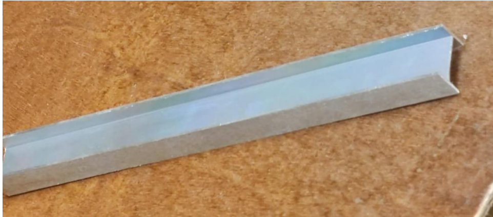
Figura 49. Diafragmas internos de soporte de lámina de acero (IIUNAM).
