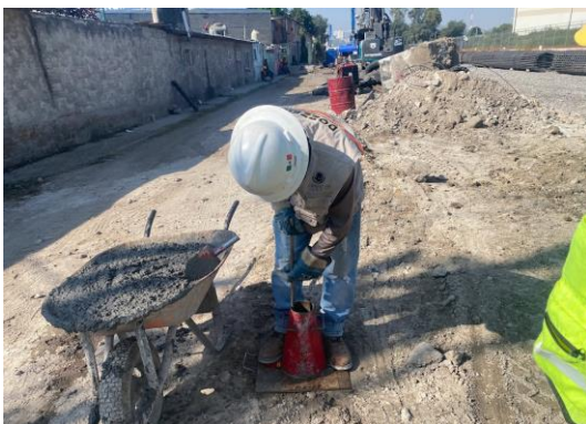
Imagen 69 y 70 Autoría Propia (2023) "Prueba de revenimiento y vaciado de concreto en cilindros muestra"
