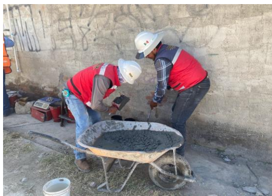
Imagen 125 y 126 Autoría Propia (2023) "Vista de toma de muestra en cilindros para prueba de resistencia a la compresión y prueba de revenimiento para concreto en columnas"
