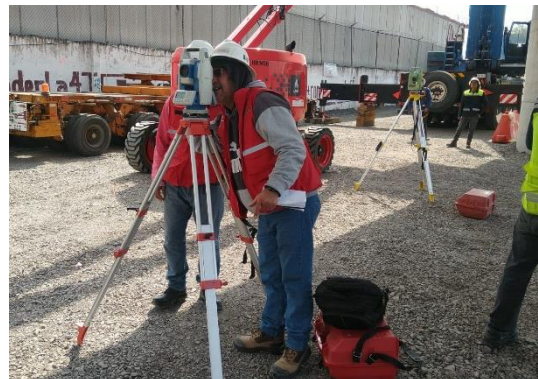
Imagen 176 y 177 Autoría Propia (2023) "Vista general de los trabajos de revisión de verticalidad en columnas"
