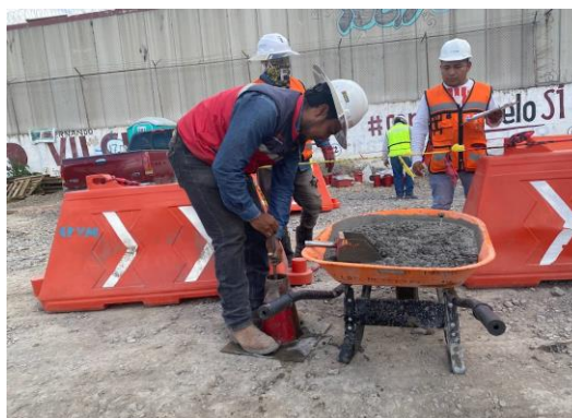
Imagen 125 y 126 Autoría Propia (2023) "Vista de toma de muestra en cilindros para prueba de resistencia a la compresión y prueba de revenimiento para concreto en columnas"
