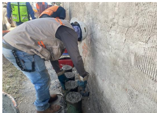
Imagen 69 y 70 Autoría Propia (2023) "Prueba de revenimiento y vaciado de concreto en cilindros muestra"
