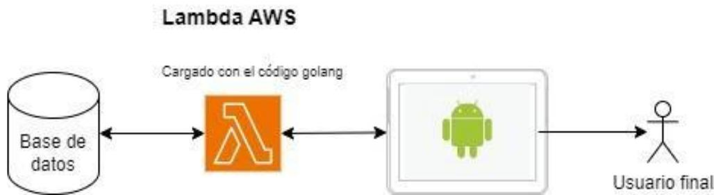
*Imagen II.2.1 Diagrama de estructura de microservicios Golang y Aplicación Android*
