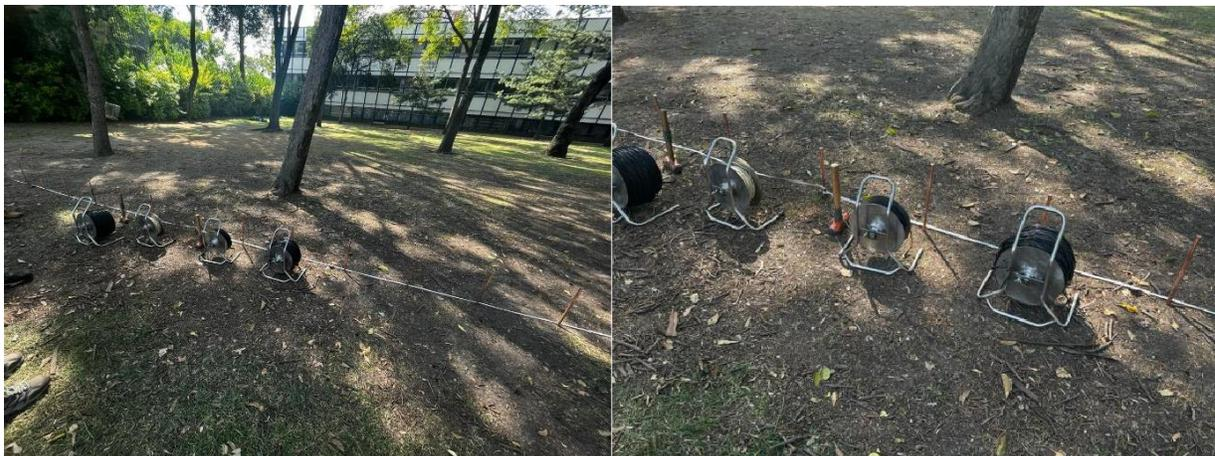
**Figura 3.1 Instrumentación y equipo de campo.** Carretes de cable y electrodos empleados para el levantamiento de los SEV en el Jardín de la ENALLT (Tovar Jara, 2024).
