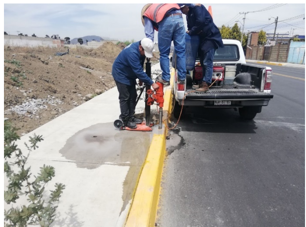
Foto 51. Extracción de núcleo en guarnición. Fuente propia.
