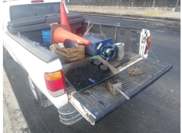
Foto 82. Briquetas para pruebas de asfalto. Fuente propia.
