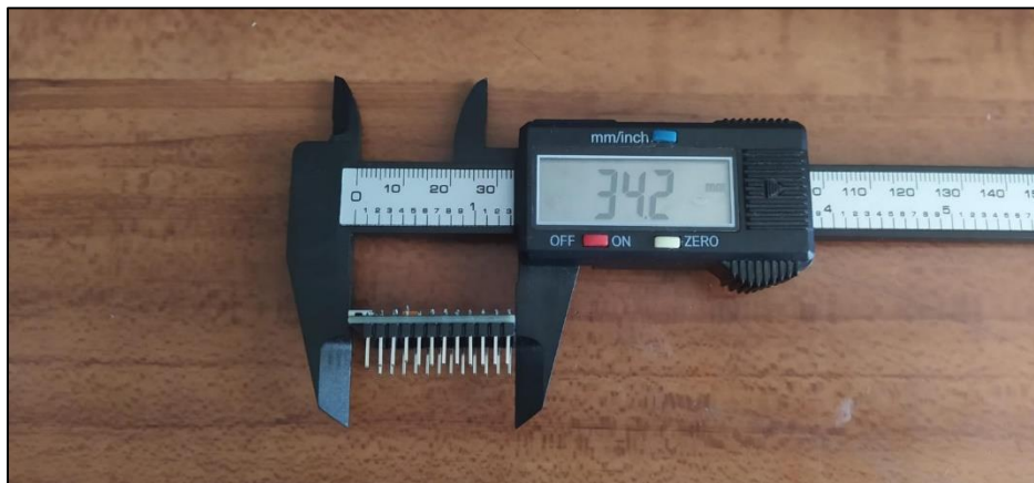
Figura 70. Medida del largo de la tarjeta Pro Micro.
