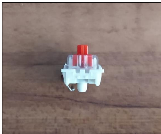
Figura 32. Interruptores mecánicos utilizados (Cherry MX red).
