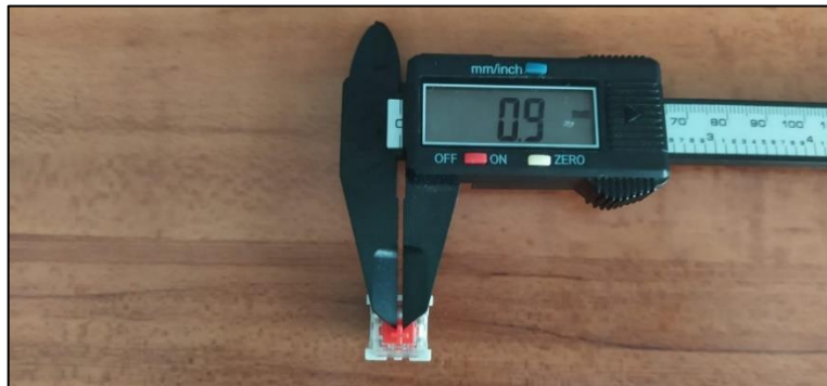
Figura 33. Toma de medidas del interruptor.
