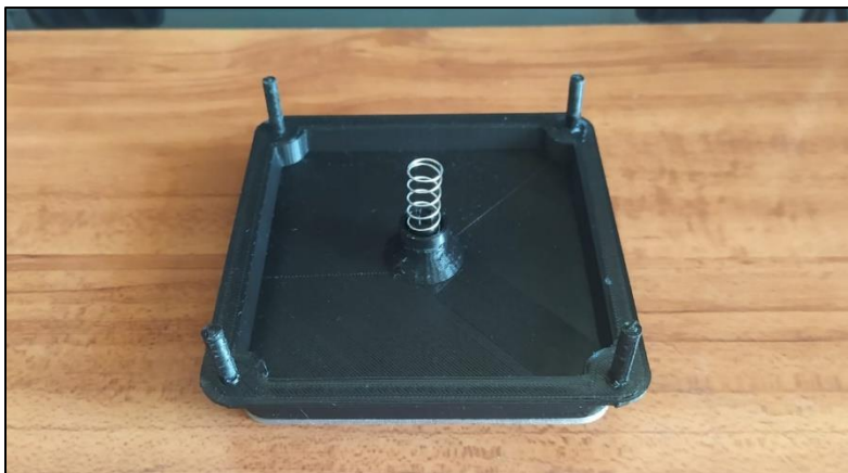
Figura 97. Resorte de retorno colocado sobre la tecla del prototipo B.
