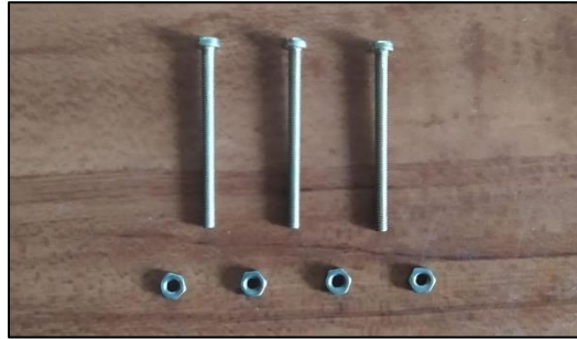
Figura 128. Tornillos M3x40 y tuercas M3.
