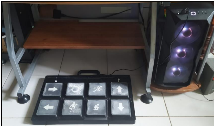
Figura 212. Conexión del teclado para pies hacia una computadora de escritorio.
