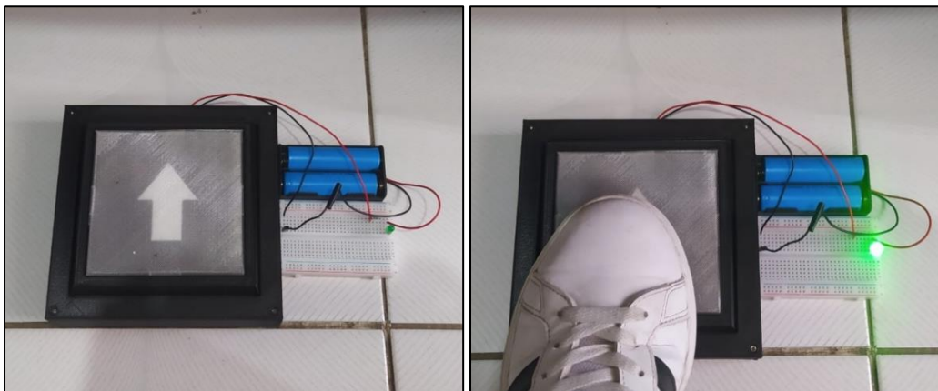
Figura 64. Prueba de pulsación del prototipo A.
