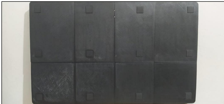
Figura 209. Almohadillas antideslizantes del teclado.
