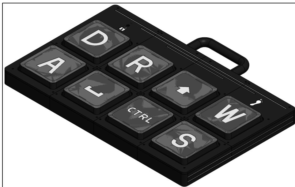
Figura 163. Vista isométrica del ensamble final del teclado con el arreglo de acciones.
