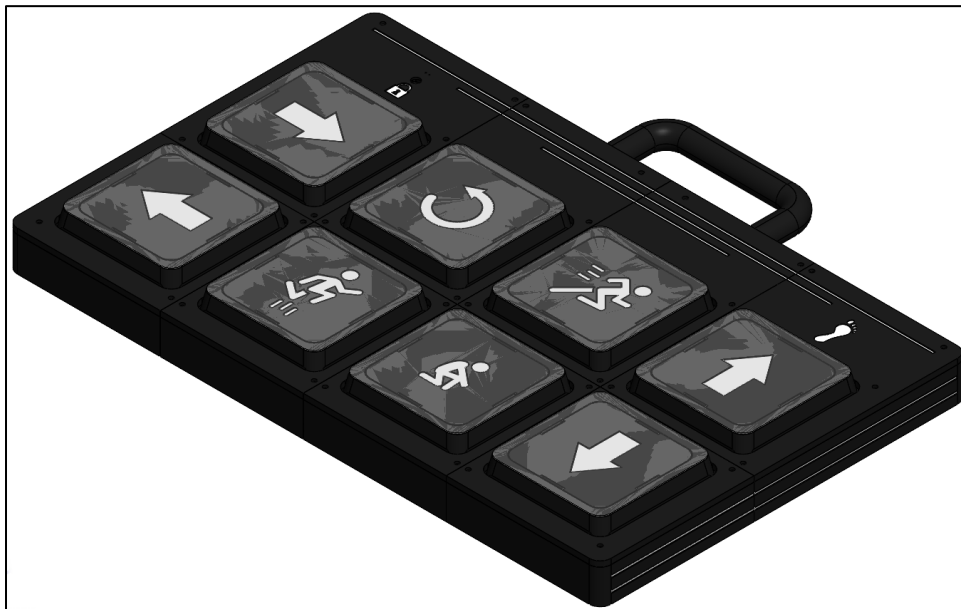
Figura 161. Vista isométrica del ensamble final del teclado con el arreglo de acciones.
