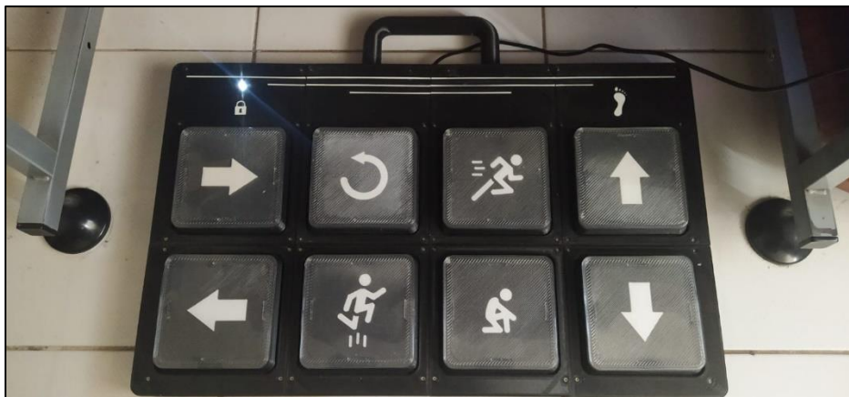
Figura 216. Teclado para pies en modo bloqueado.
