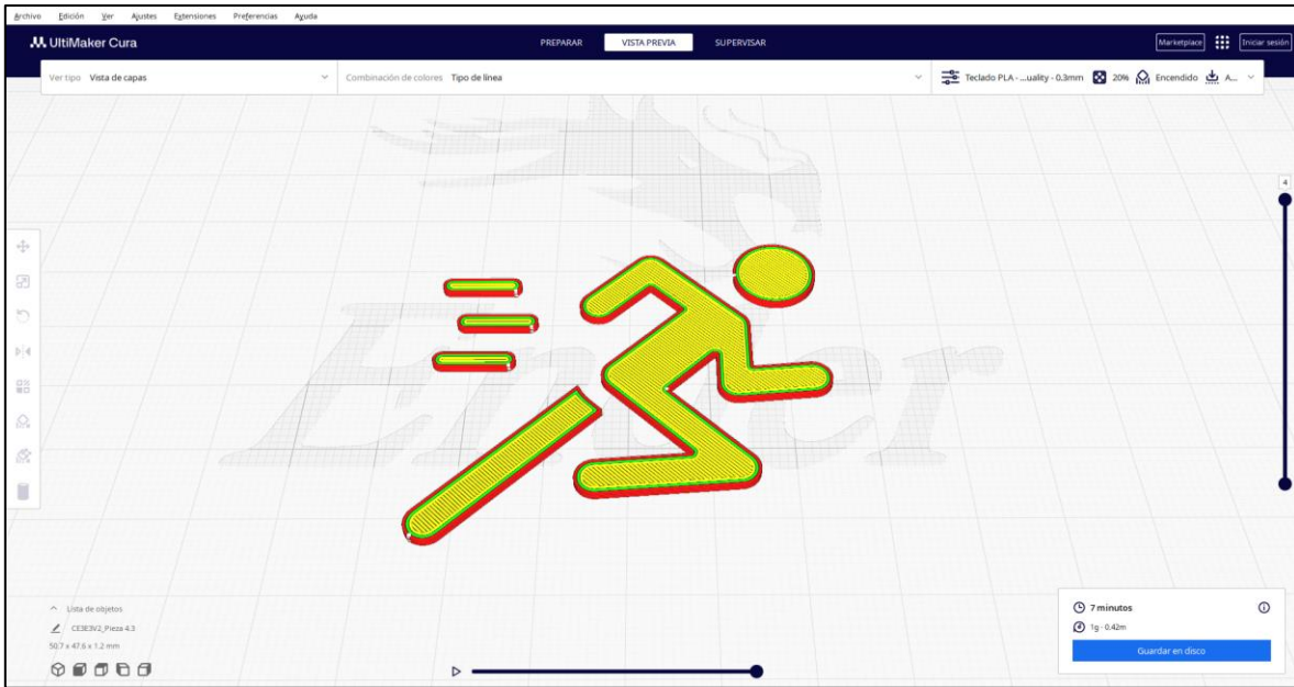
Figura 165. Pieza de logotipo segmentada por el laminador.
