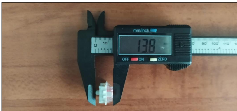
Figura 46. Medición de la altura del interruptor.
