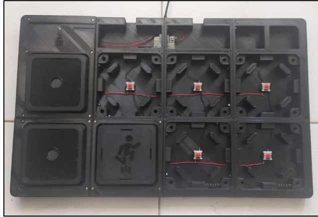
Figura 202. Cableado del teclado.
