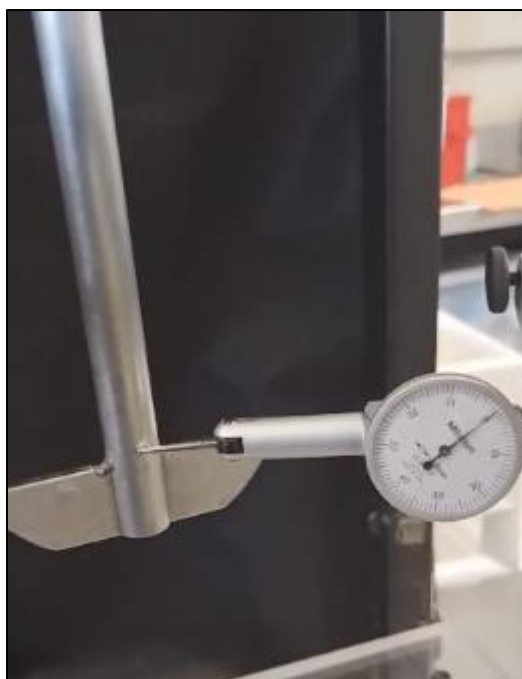
Figura 20. Oscilación del elemento de agitación (Elaboración propia).
