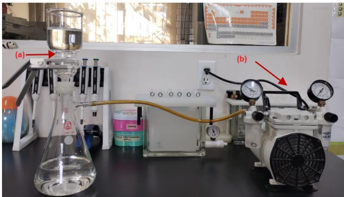
Figura 30. Imagen del sistema de filtración (a) equipo de microfiltración; (b) Bomba de vacío (Elaboración propia).
