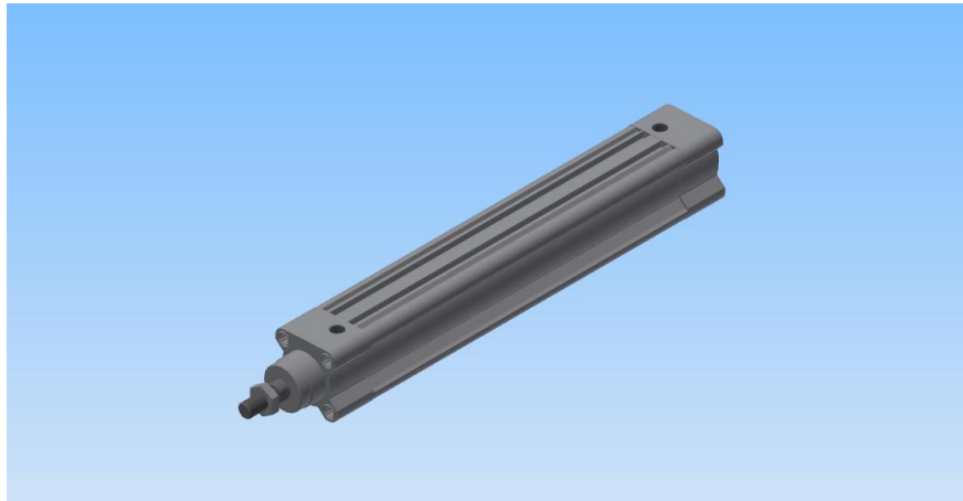
Figura 3.12. Modelo CAD de los cilindros utilizados en la implementación de gemelos digitales y proporcionados por Festo® [36]. El cilindro consta de un vástago y el cuerpo del cilindro. Además, posee una tuerca situada en el vástago la cual no fue requerida.
