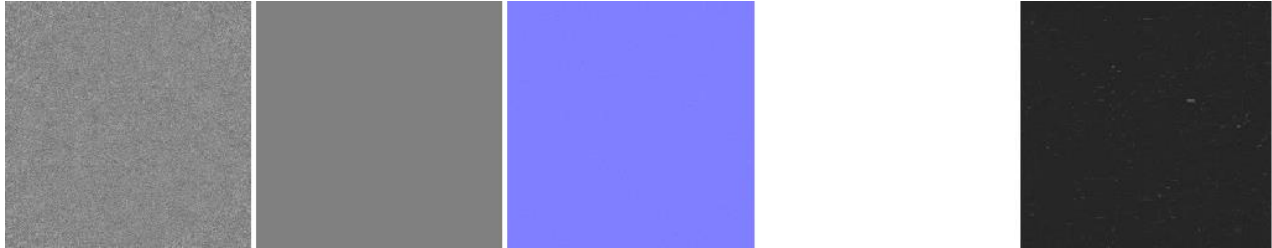
Figura 3.94. Imágenes PBR para la representación de un material metálico. De izquierda a derecha: Textura (color), altura ( height ), Normales ( normal map ), Metálico ( metallic ), Rugosidad ( roughness ). La textura metálico no se alcanza a apreciar mucho ya que es casi blanca.
