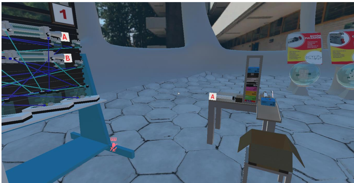
Figura 6.9. El cilindro A regresa a su posición original (movimiento A-). Los paquetes restantes en el soporte almacenador caen por gravedad.
