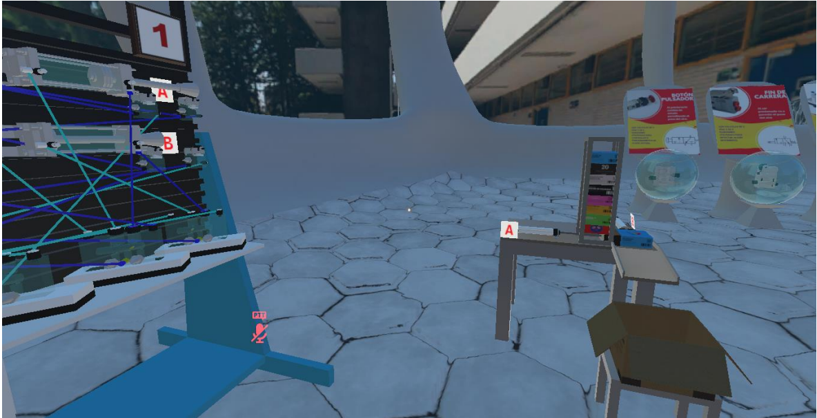
Figura 6.8. El paquete se empuja desde el soporte contenedor con la expansión del cilindro A. Se observa que los cilindros A de la mesa de trabajo y del gemelo digital se han expandido. También se observa que se creó un paquete nuevo en la parte superior del soporte contenedor de paquetes.
