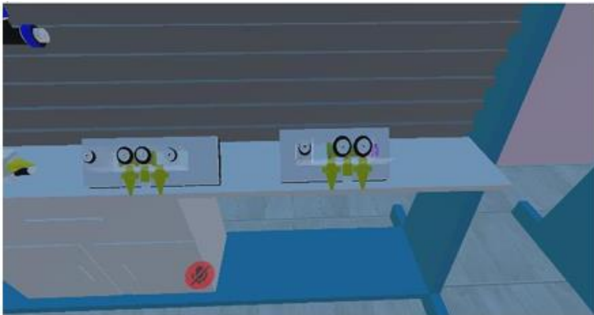
Figura 2.11. Acercamientos a las válvulas 5/2 virtuales del LaVNeuM. Válvula 5/2 biestable de accionamiento neumático (izquierda) y válvula 5/2 monoestable de accionamiento neumático (derecha). Tomado de [16].
