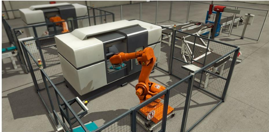
Figura 1.1. El simulador Factory I/O es un simulador comercial destinado al aprendizaje de las tecnologías de automatización y es un ejemplo de un gemelo Digital. Tomado de [3].
