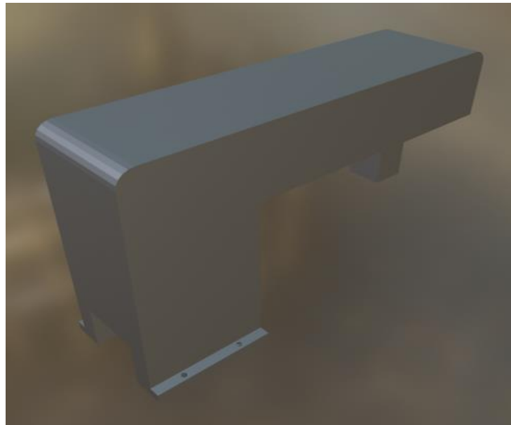
Figura 3.92. Soporte del cilindro B de la estampadora una vez que se agregaron texturas.
