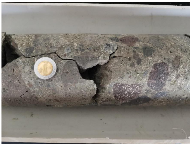
Figura 43. Fragmento perteneciente al núcleo N-Mirador-2 T-2 en el cual se observa la presencia de clastos sub-redondeados.
