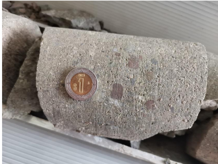
Figura 38. Fragmento perteneciente al núcleo N-Mirador-2 T-4 en el cual se observa la presencia de clastos pequeños redondeados.
