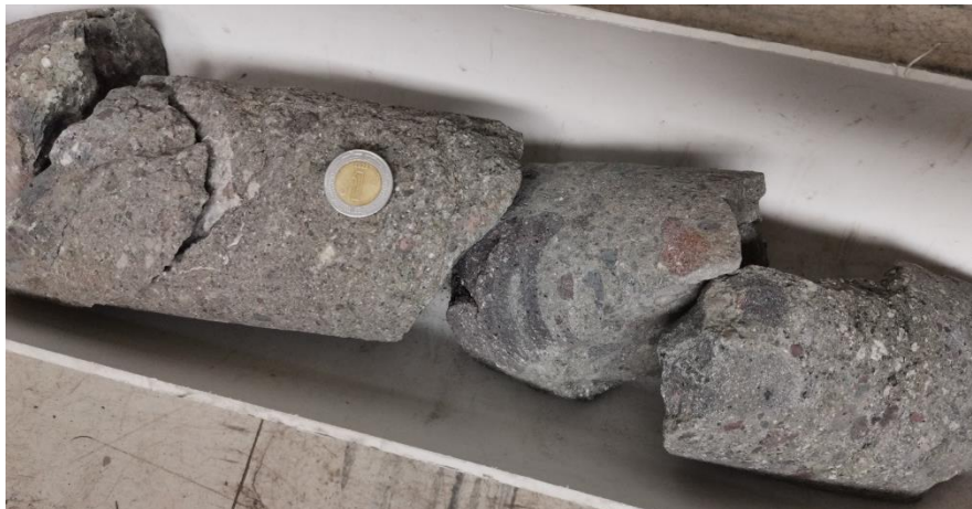
Figura 40. Fragmento perteneciente al núcleo N-Mirador-2 T-3 en el cual se observa la presencia de clastos pequeños sub-redondeados.
