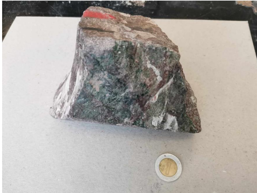
Figura 36. Fragmento perteneciente al núcleo N-Mirador-2 T-6 en el cual se observa la presenta una coloración verdosa y estrías de falla.
