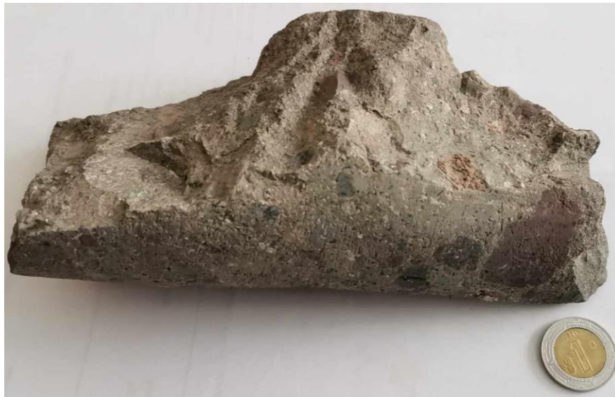
Figura 35. Fragmento perteneciente al núcleo N-Mirador-2 T-6 en el cual se observa la presencia de clastos angulosos grandes.
