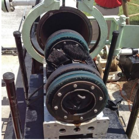
Figura 2.12 Elemento de limpieza interna en ductos (Ducamsa, n.d.).
