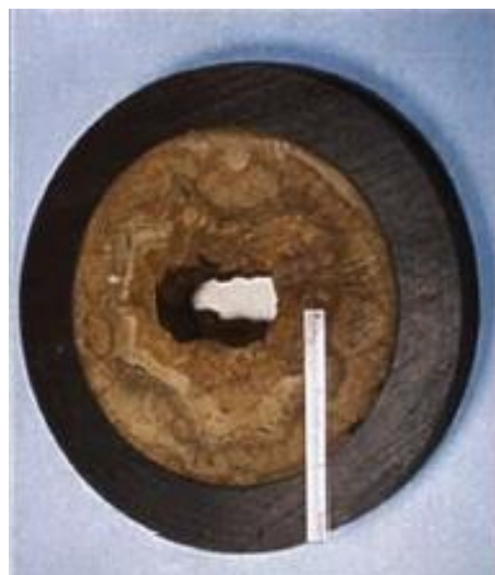
Figura 1.12 Ejemplo de un depósito de parafina en una tubería (Huang et al., 2016).
