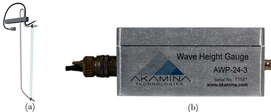
Figura 9. Sistema Akamina Technologies (2016): (a) sensor medidor de tirante de agua de tipo arco; (b) dispositivo al cual se conecta el sensor.
