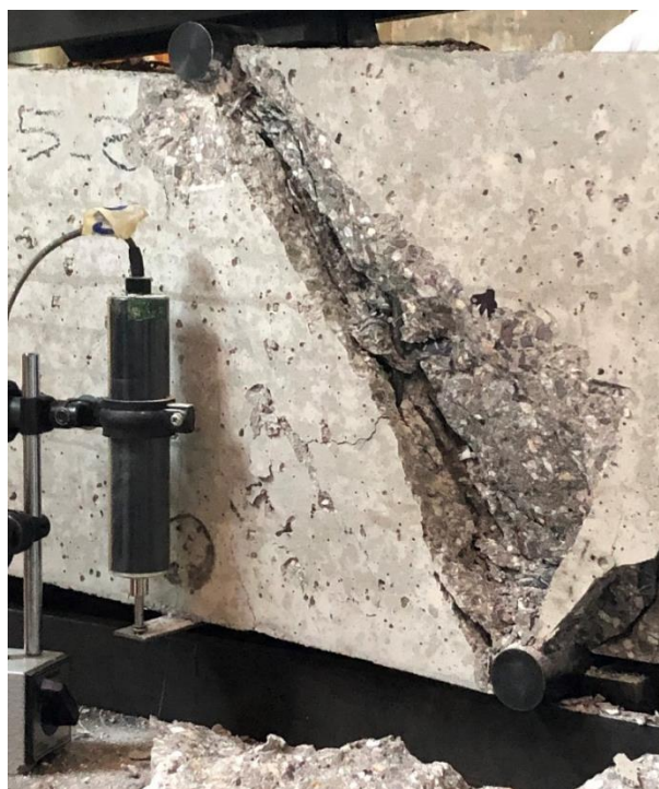
Figura 4. 21. - Detalle de la falla en apoyo de frente en la viga V2-1539 después de llevarla a la falla donde se puede ver a la viga apoyándose en la base del rodillo. Foto tomada por Bibian I. Silva.
