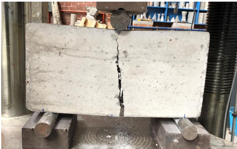
Figura 4. 114. - Viga V1-2246 después de llevarla a la falla con vista frontal. Foto tomada por Bibian I. Silva.
