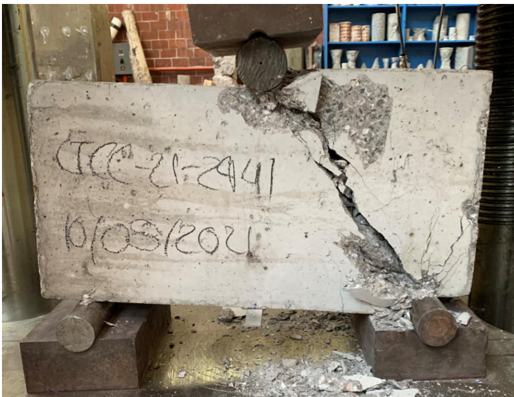
Figura 4. 136. – Viga V1-2441 después de llevarla a la falla (vista frontal).
