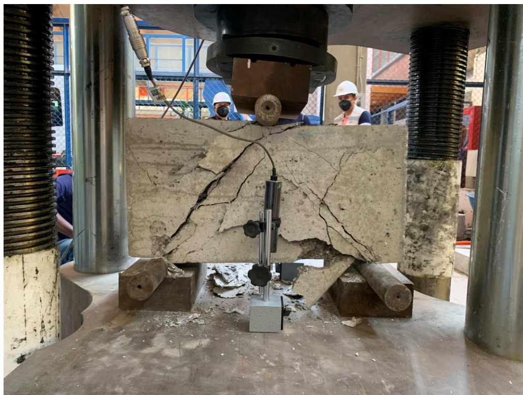
Figura 4. 23. - Viga V3-1539 después de llevarla a la falla (vista posterior).
