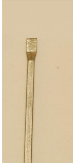
Figura 2. 5. - Fotografías de la mitad de una fibra con extremos planos (Garber, 2014).
