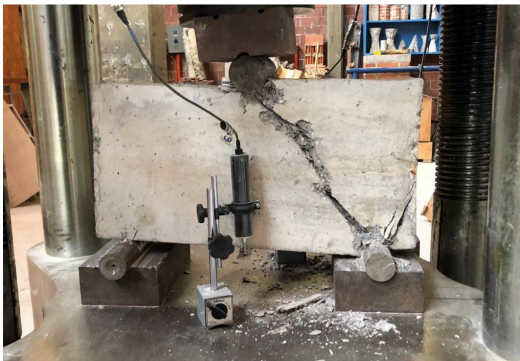
Figura 4. 95. - Viga V2-2102 después de llevarla a la falla vista de frente. Foto tomada por Bibian I.
