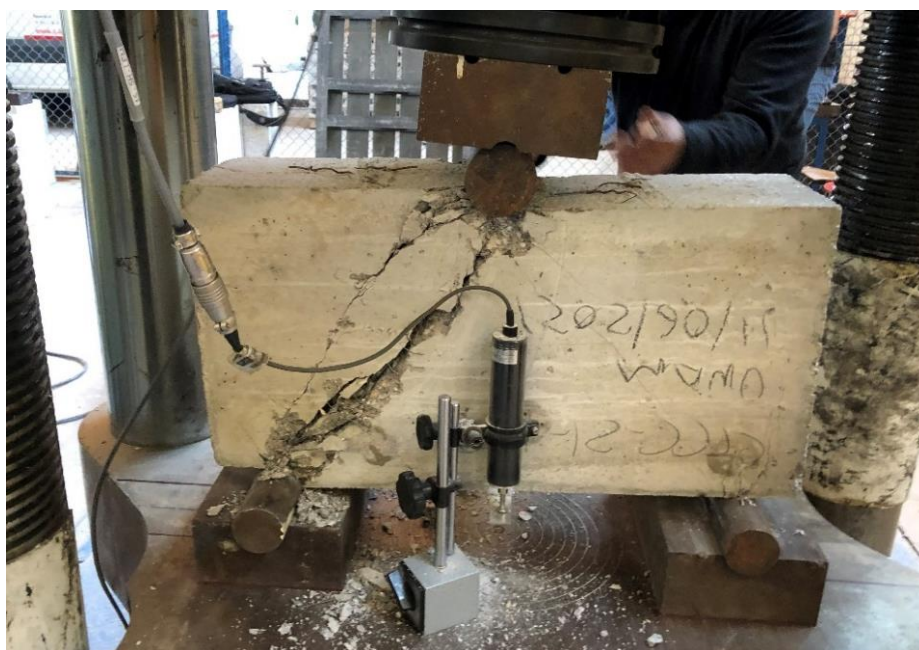
Figura 4. 65. - Viga V1-1857 después de llevarla a la falla con vista posterior.
