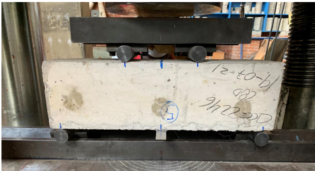
Figura 4. 7. - Especimen 2246-5 con arreglo para falla a flexión.
