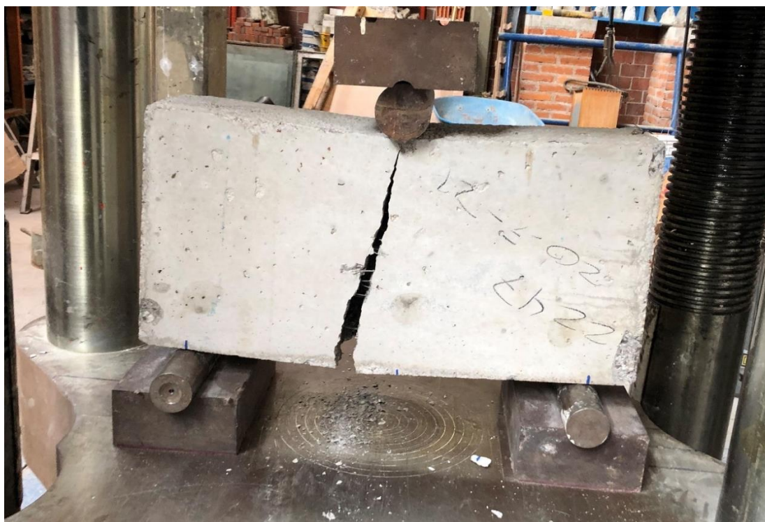
Figura 4. 121. - Viga V1-2247 después de llevarla a la falla con vista frontal. Foto tomada por Bibian I.
