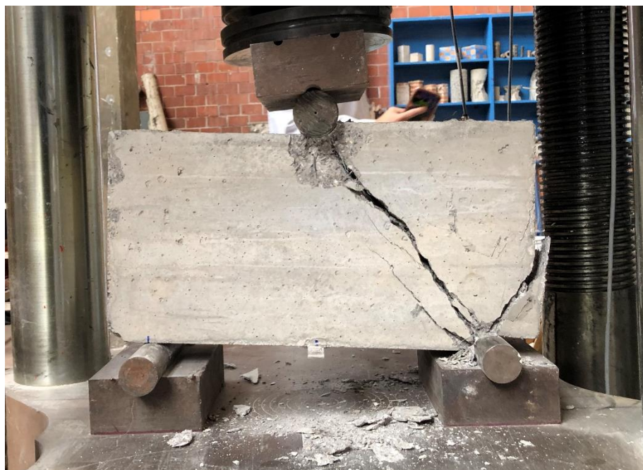
Figura 4. 111. - Viga V1-2230 después de llevarla a la falla con vista frontal. Foto tomada por Bibian I.
