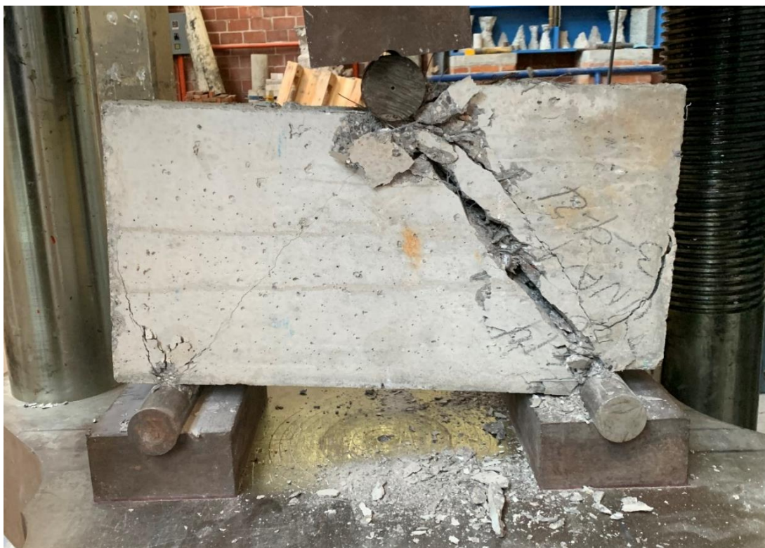
Figura 4. 160. – Viga V3-2614 después de llevarla a la falla con vista frontal.
