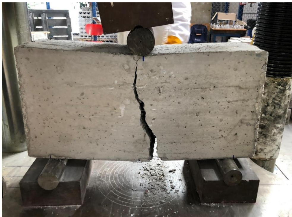
Figura 4. 116. - Viga V2-2246 después de llevarla a la falla con vista posterior. Foto tomada por Bibian I. Silva.
