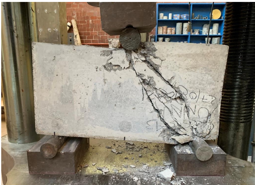
Figura 4. 150. – Viga V1-2543 después de llevarla a la falla con vista frontal.
