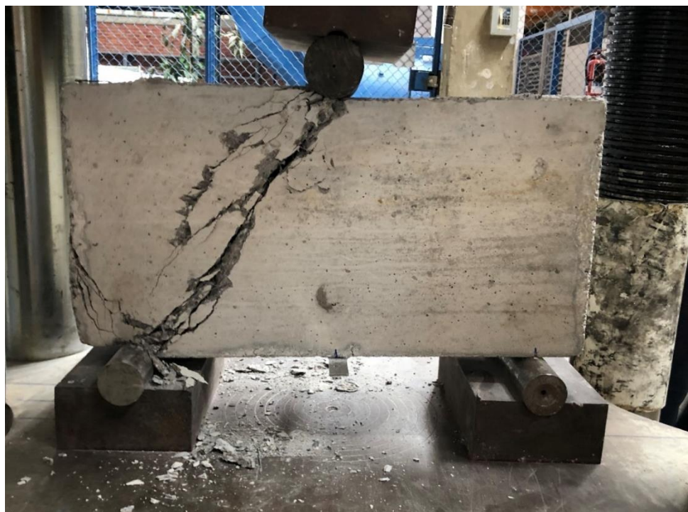
Figura 4. 107. - Viga V1-2230 después de llevarla a la falla con vista posterior. Foto tomada por Bibian I. Silva.
