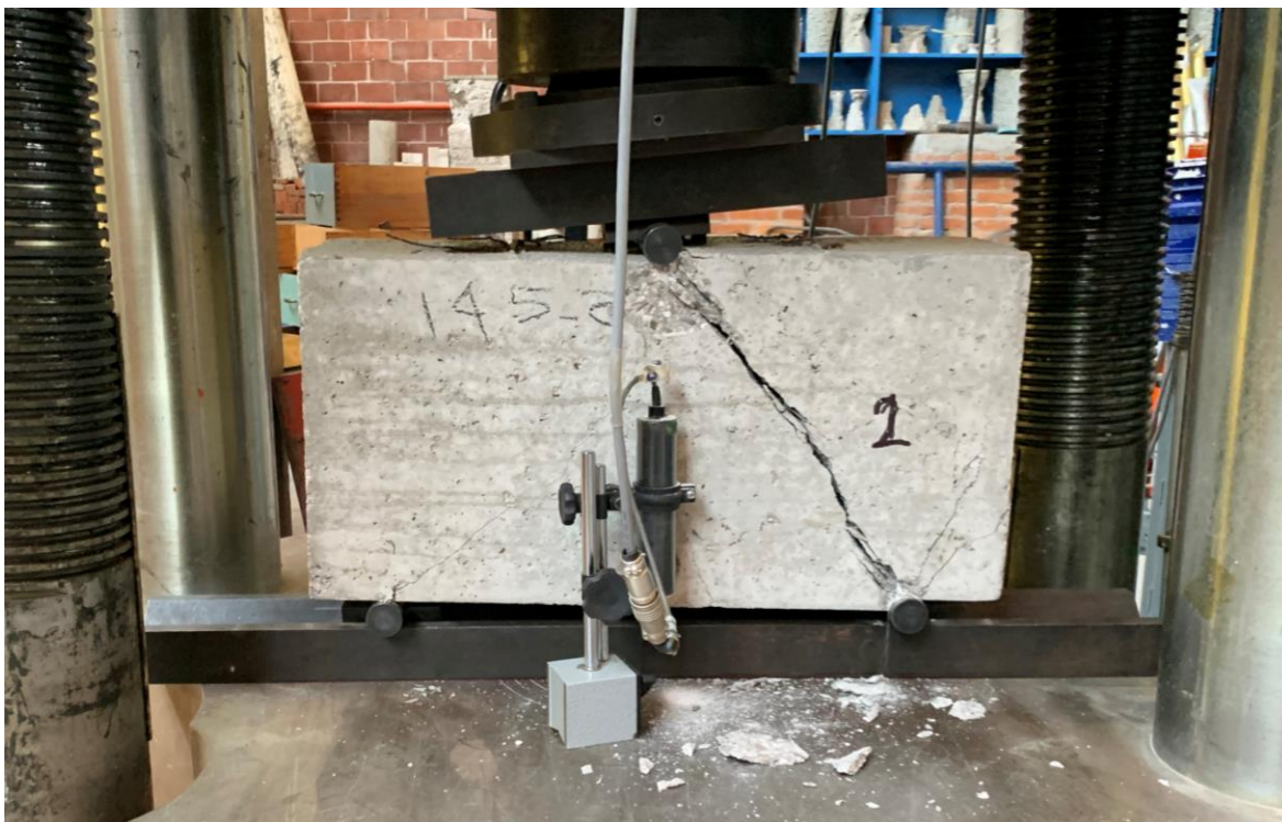
Figura 4. 20. - Viga V2-1539 después de llevarla a la falla (vista de frente).
