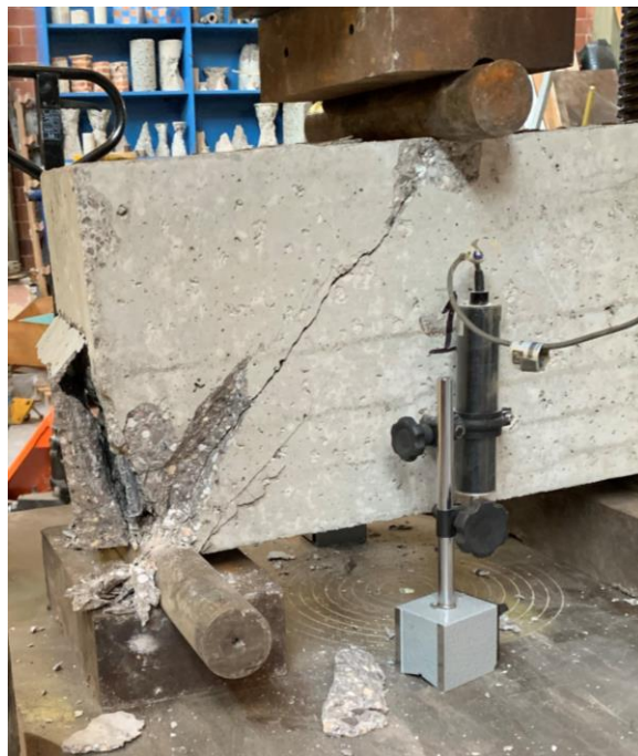
Figura 4. 18. - Detalle de la falla en apoyo de frente en la viga V1-1539 después de llevarla a la falla.
