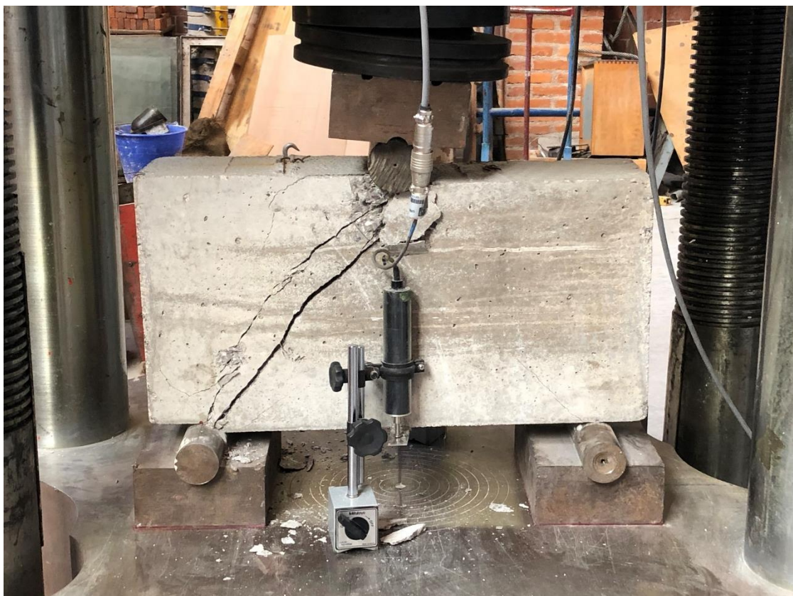
Figura 4. 50. - Viga V2-1709 después de llevarla a la falla vista de frente.
