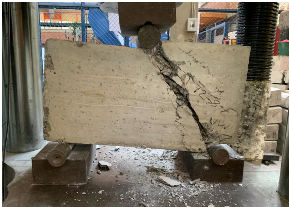
Figura 4. 147. – Viga V3-2542 después de llevarla a la falla con vista posterior.
