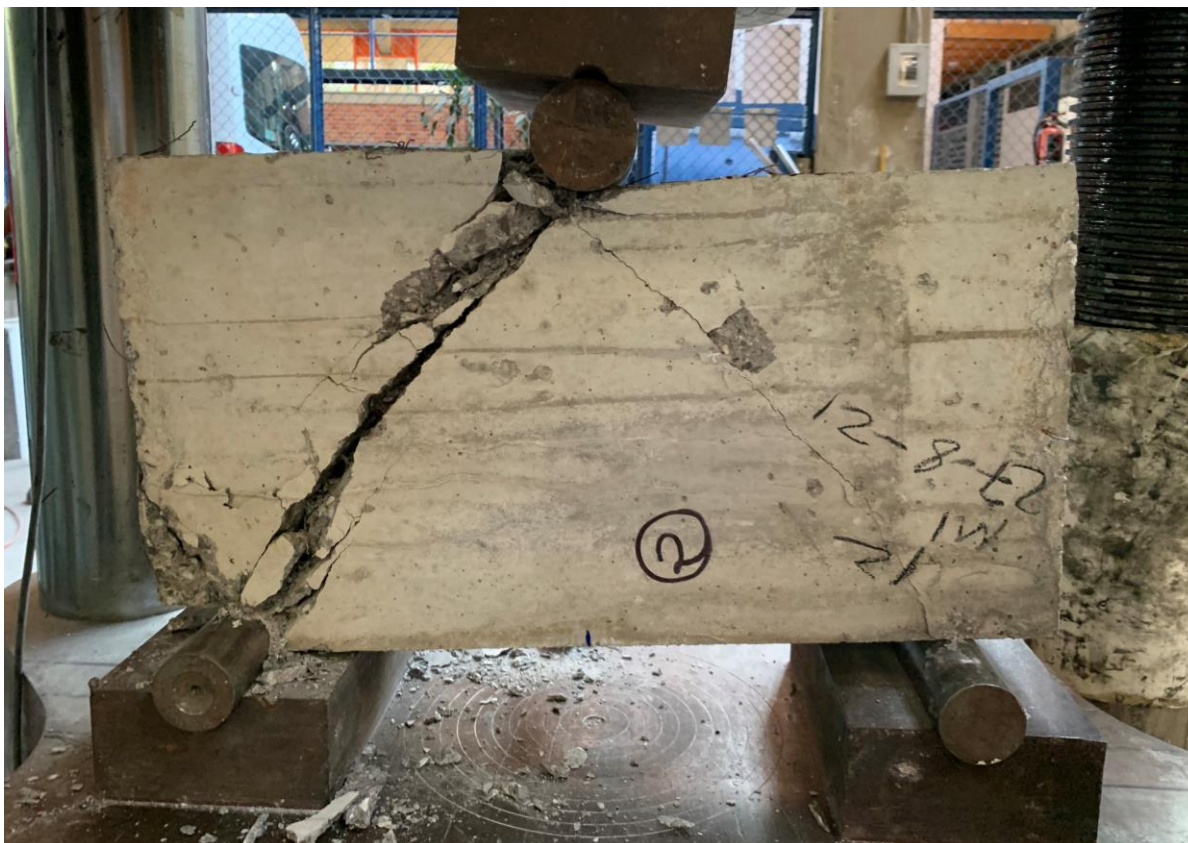
Figura 4. 145.- Viga V2-2542 después de llevarla a la falla con vista posterior.
