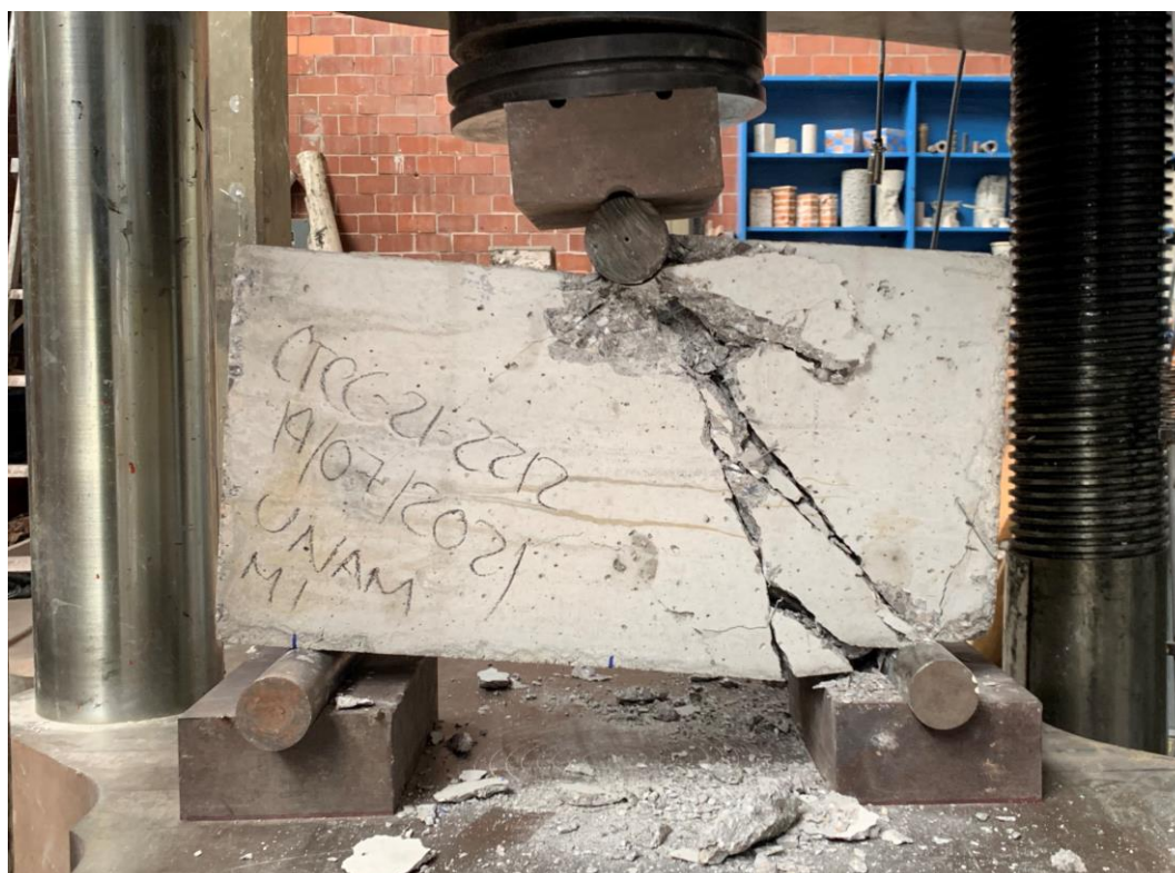
Figura 4. 104. - Viga V3-2212 después de llevarla a la falla vista de frente.
