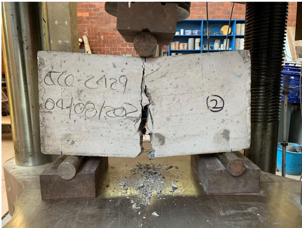
Figura 4. 131. – Viga V2-2429 después de llevarla a la falla con vista frontal.
