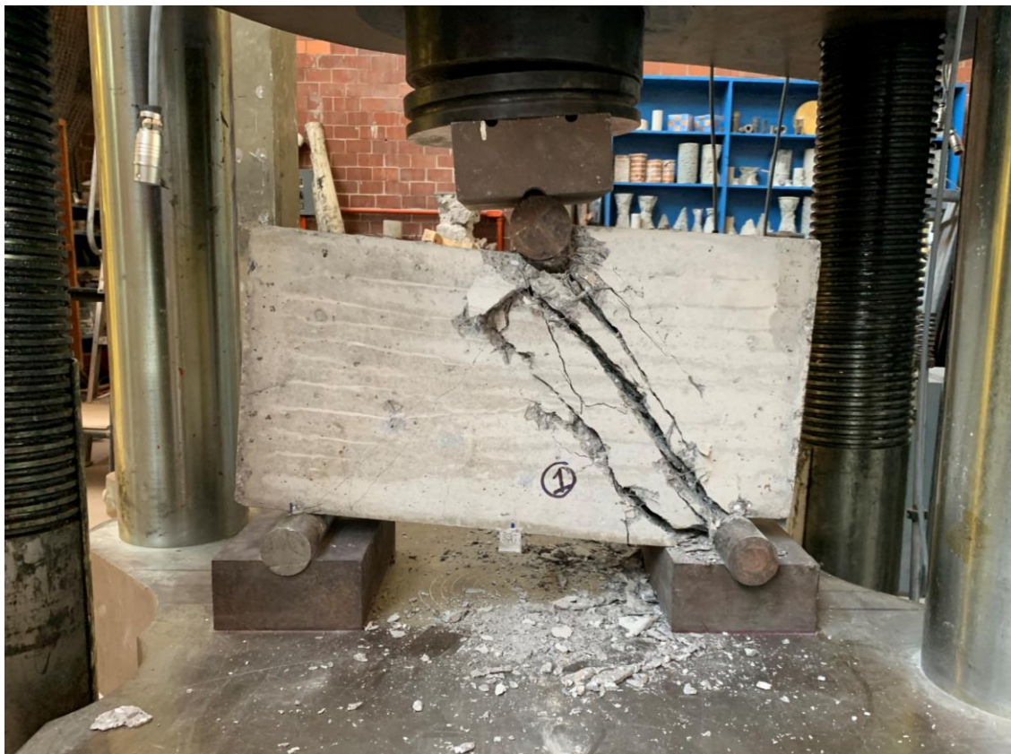
Figura 4. 143.- Viga V1-2542 después de llevarla a la falla con vista frontal.
