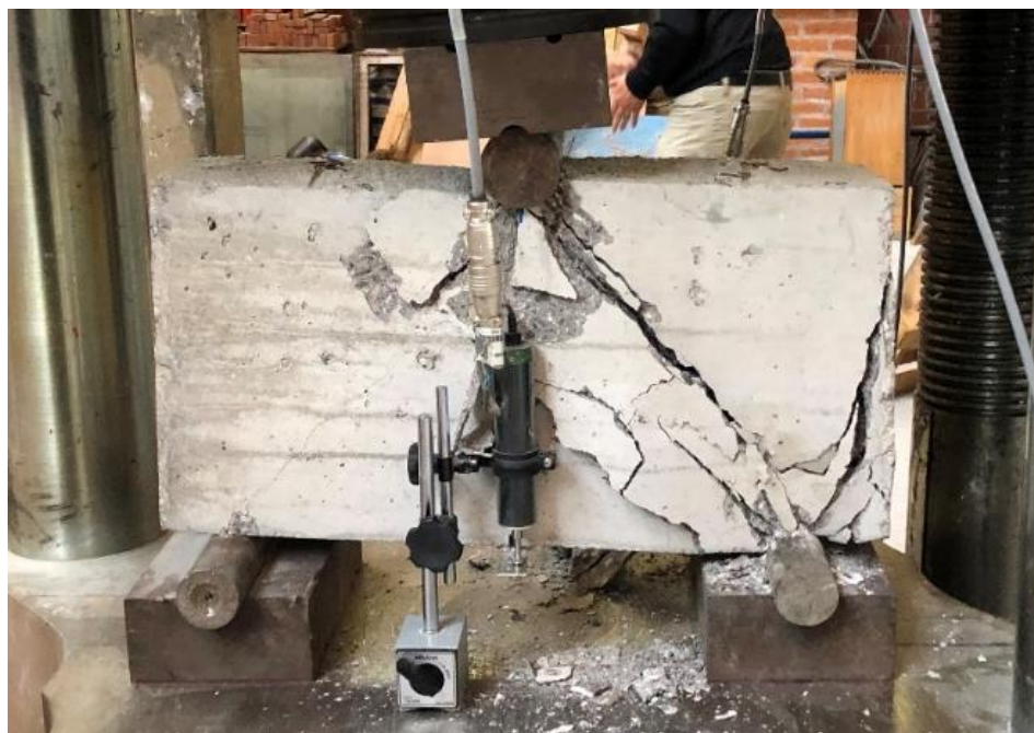
Figura 4. 79. - Viga V1-1979 después de llevarla a la falla vista de frente.
