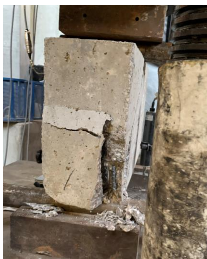
Figura 4. 17. - Detalle de falla en apoyo en la viga V1-1539 después de llevarla a la falla.
