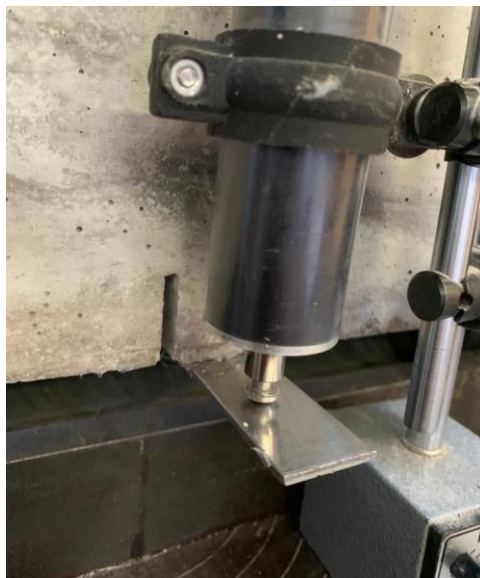
Figura 4. 9. - Detalle del montaje de equipo de medición en viga con ranura especificada por norma europea EN-14651-2005-A1.
