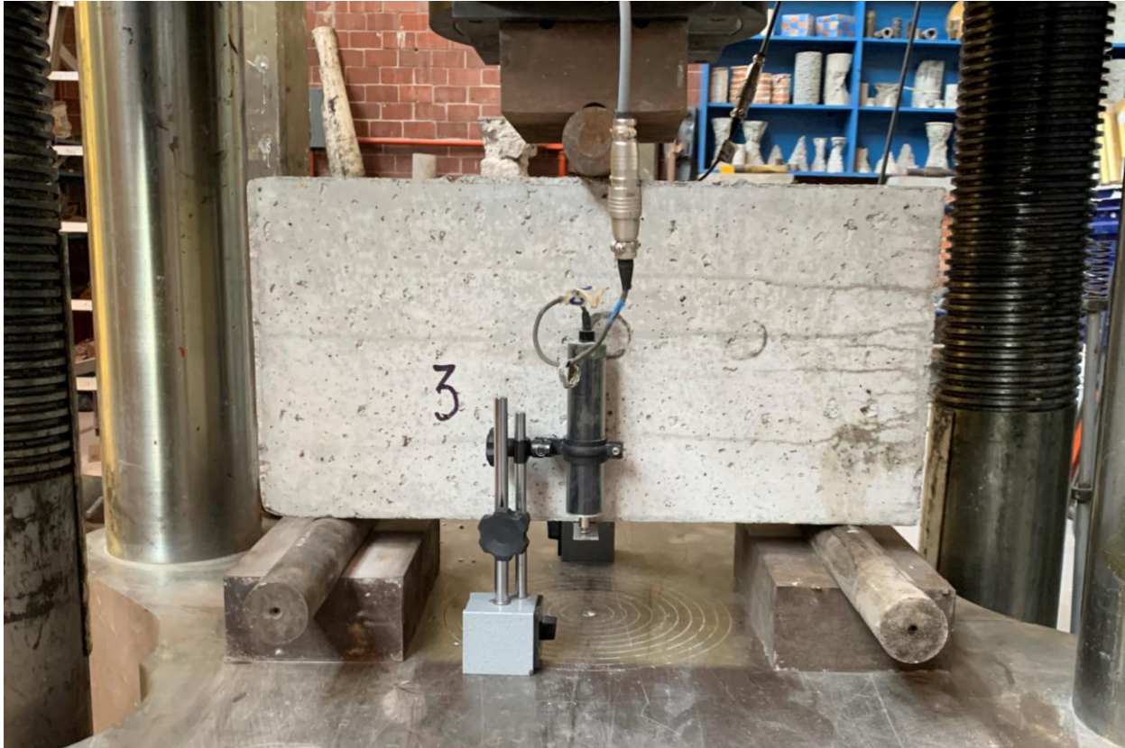
Figura 4. 6. - Espécimen 1539-3 con arreglo para falla a cortante instrumentado con transductores.
