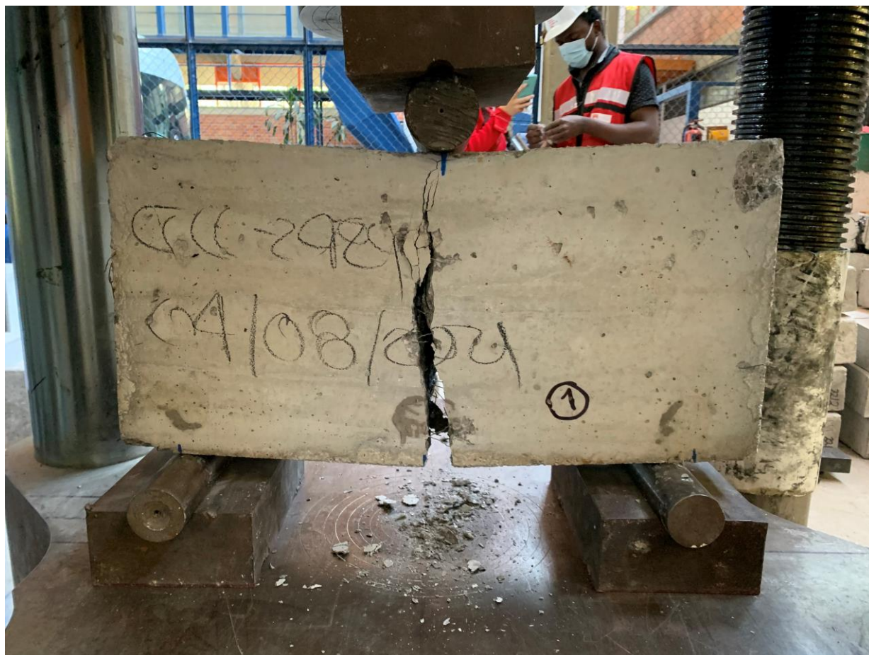
Figura 4. 129. – Viga V1-2429 después de llevarla a la falla con vista frontal.
