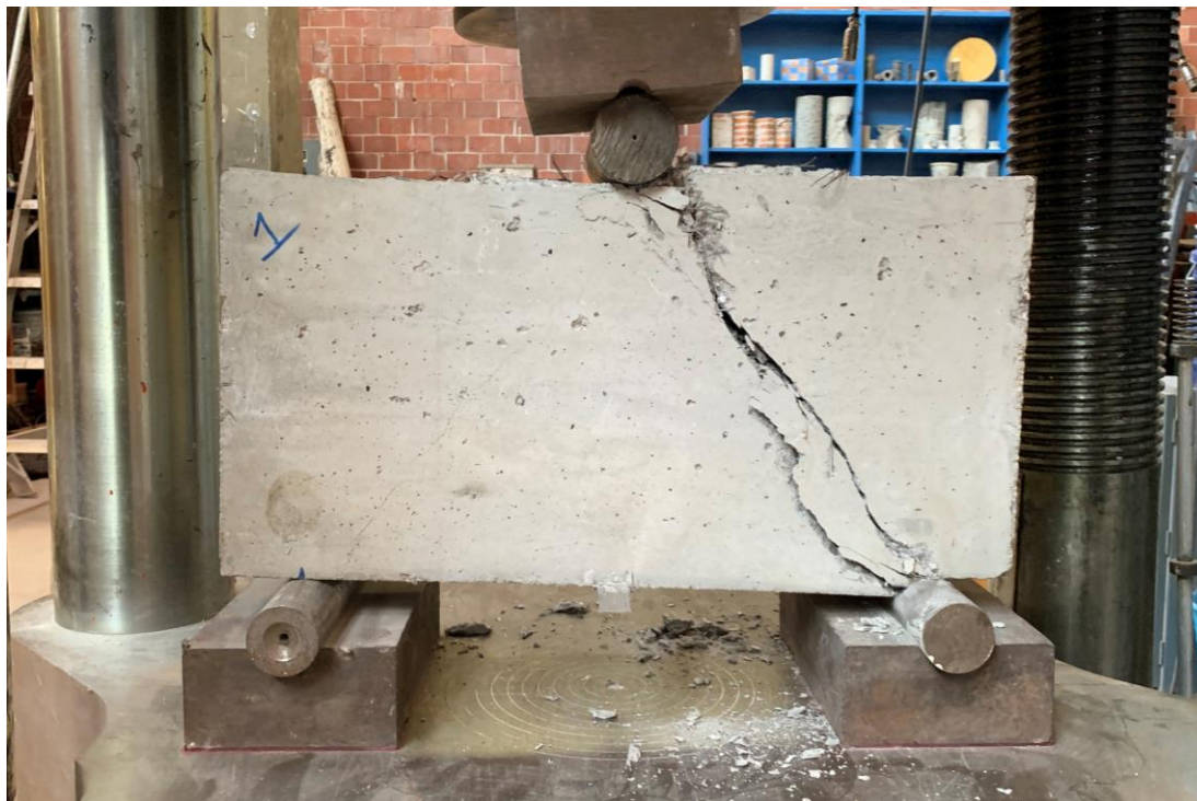
Figura 4. 41. - Viga V1-1690 después de llevarla a la falla vista de frente.
