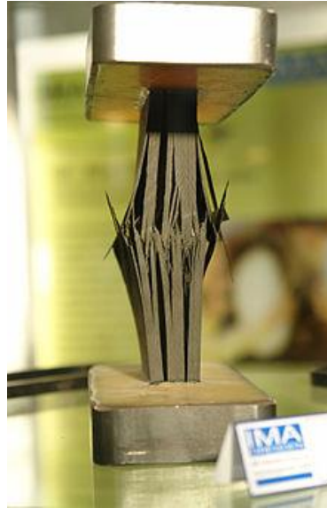
Figura 2. 9.- Fibro-compuesto que muestra falla por delaminación ( Wikipedia, 2022 ).
