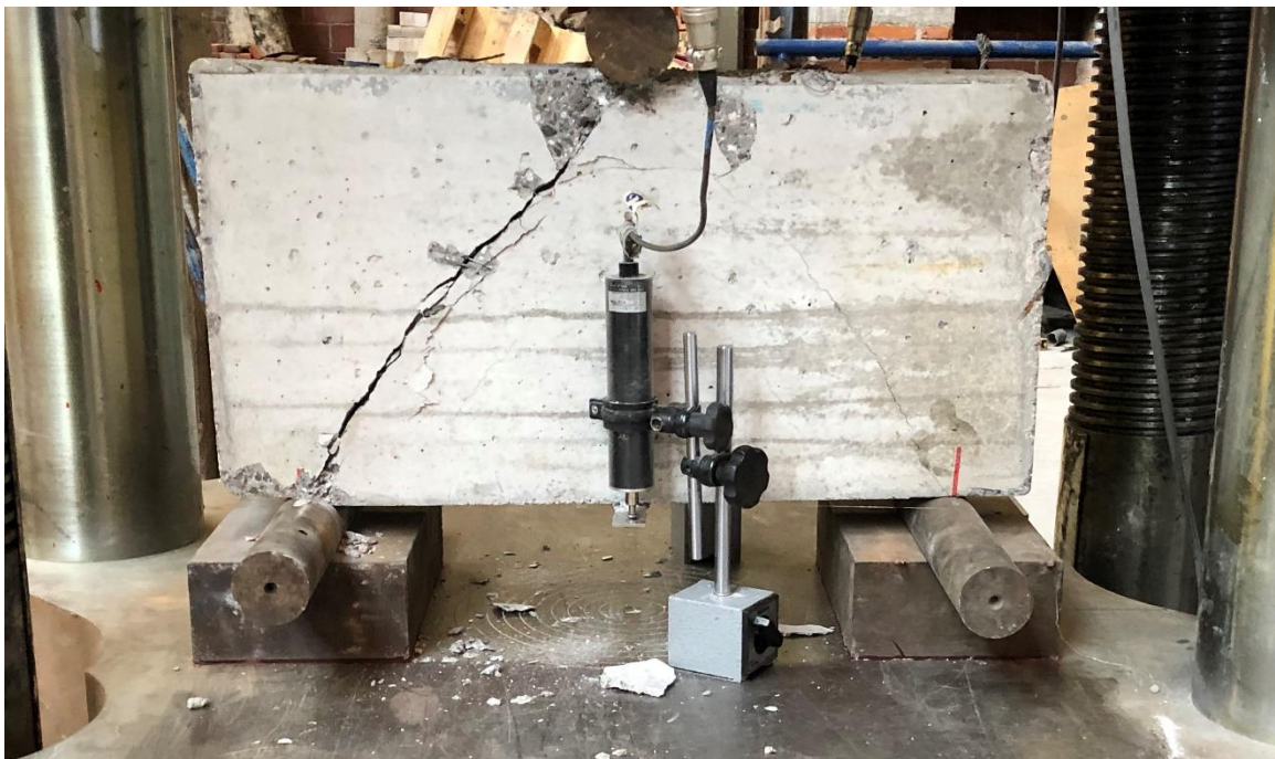
Figura 4. 34. - Viga V1-1610 después de llevarla a la falla (vista frontal). Foto tomada por Bibian I. Silva.
