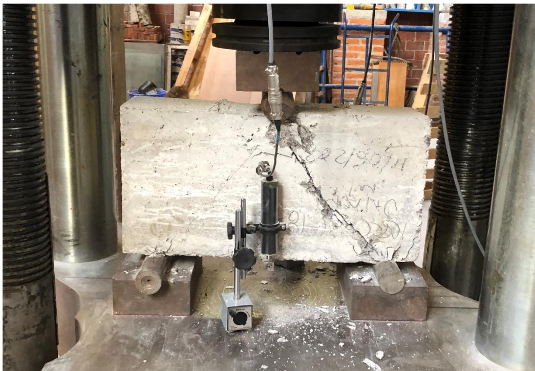
Figura 4. 69. - Viga V3-1857 después de llevarla a la falla vista de frente.
