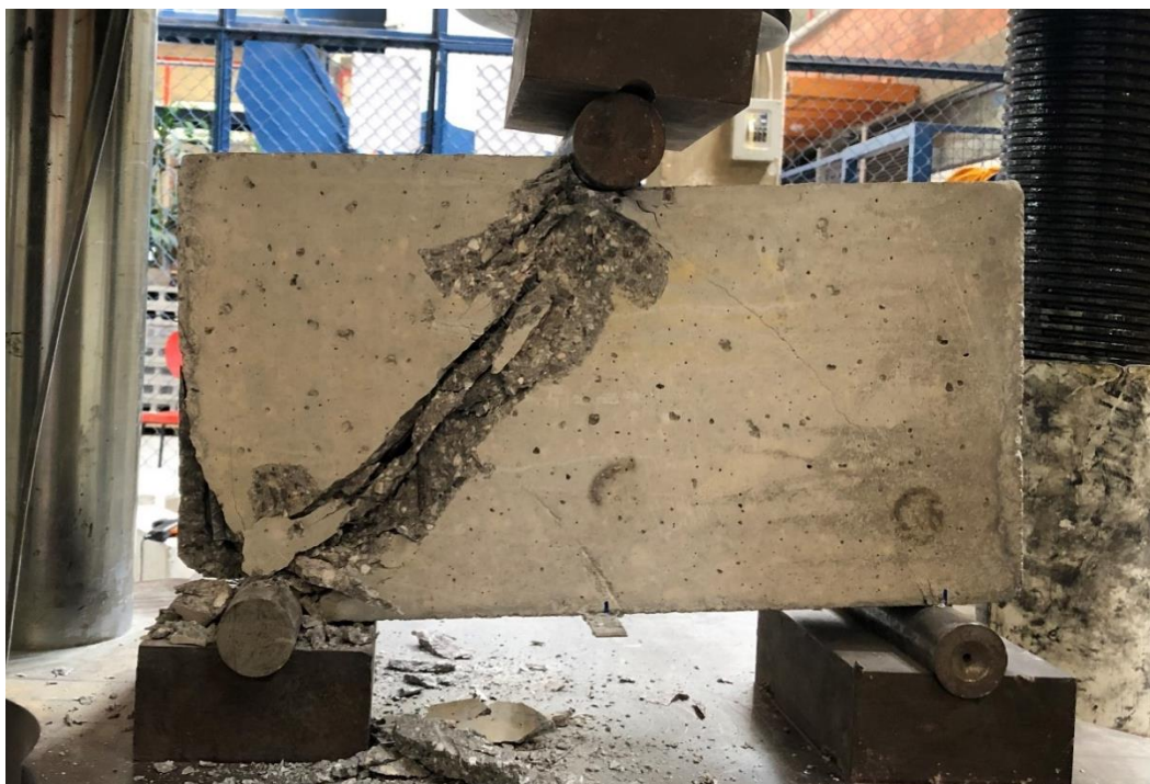
Figura 4. 102. - Viga V2-2212 después de llevarla a la falla vista de frente. Foto tomada por Bibian I.
