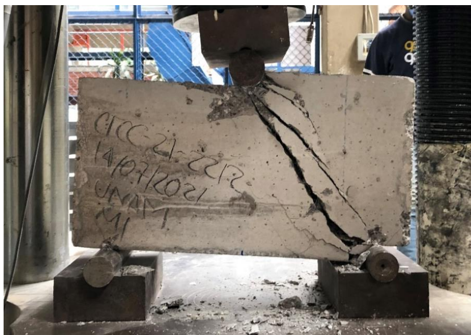
Figura 4. 100. – Viga V1-2212 después de llevarla a la falla vista de frente. Foto tomada por Bibian I.
