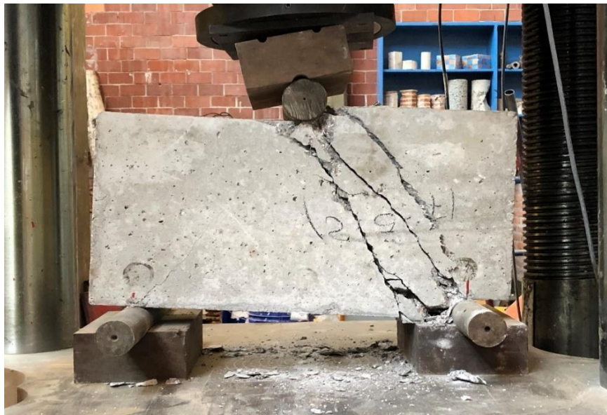
Figura 4. 31. - Viga V3-1571 después de llevarla a la falla en vista frontal. Foto tomada por Bibian I. Silva.
