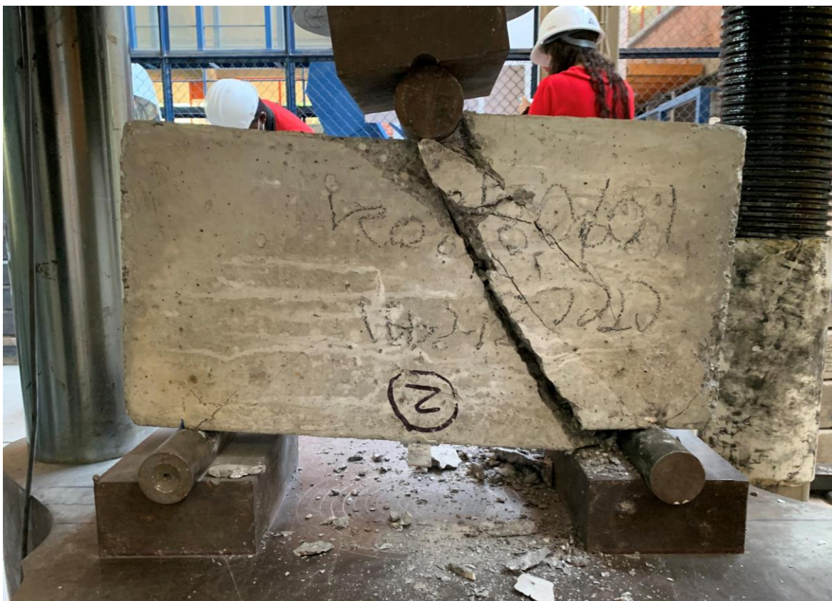
Figura 4. 138. – Viga V2-2441 después de llevarla a la falla con vista posterior.
