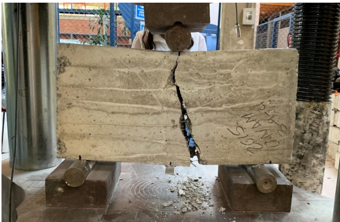
Figura 4. 163. – Viga V1-2615 después de llevarla a la falla con vista frontal.
