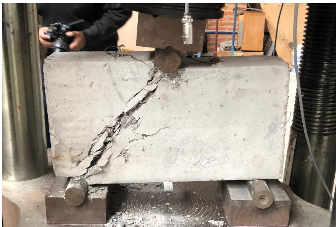
Figura 4. 62. - Viga V3-1787 después de llevarla a la falla vista de frente.
