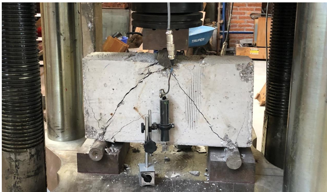
Figura 4. 83. - Viga V3-1979 después de llevarla a la falla vista de frente.
