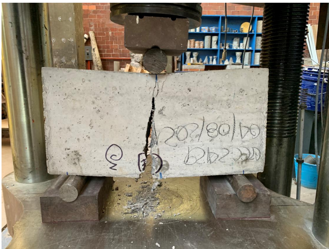
Figura 4. 133. – Viga V2-2429 después de llevarla a la falla con vista frontal.
