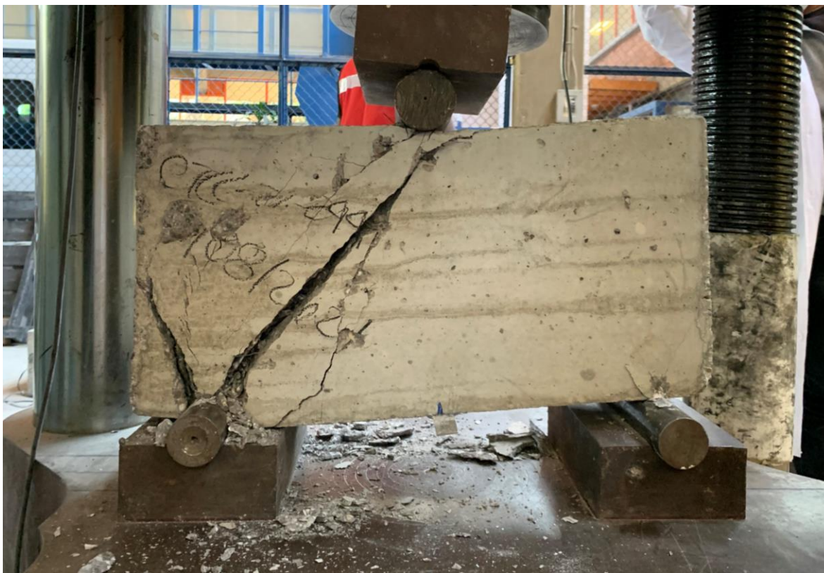
Figura 4. 140. – Viga V3-2441 después de llevarla a la falla con vista posterior.
