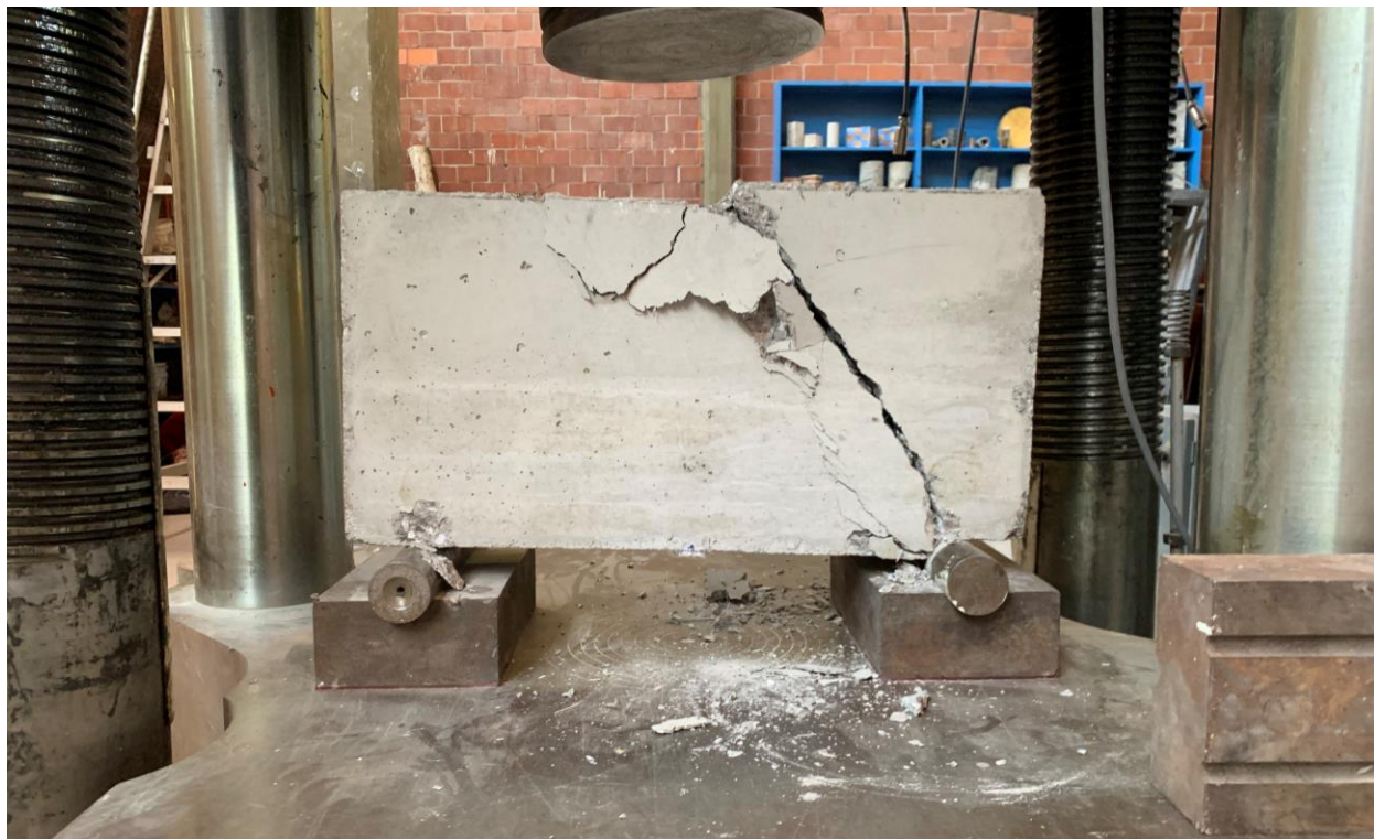
Figura 4. 45. - Viga V3-1690 después de llevarla a la falla vista de frente.
