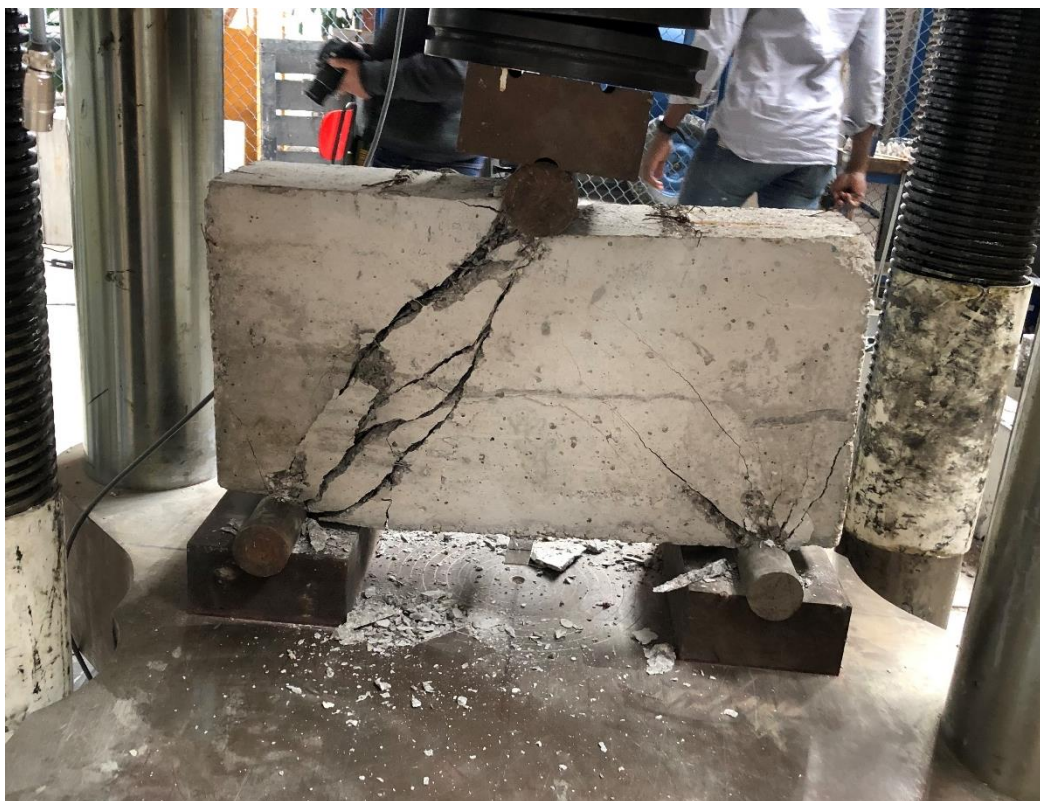
Figura 4. 59. - Viga V2-1787 después de llevarla a la falla con vista posterior.
