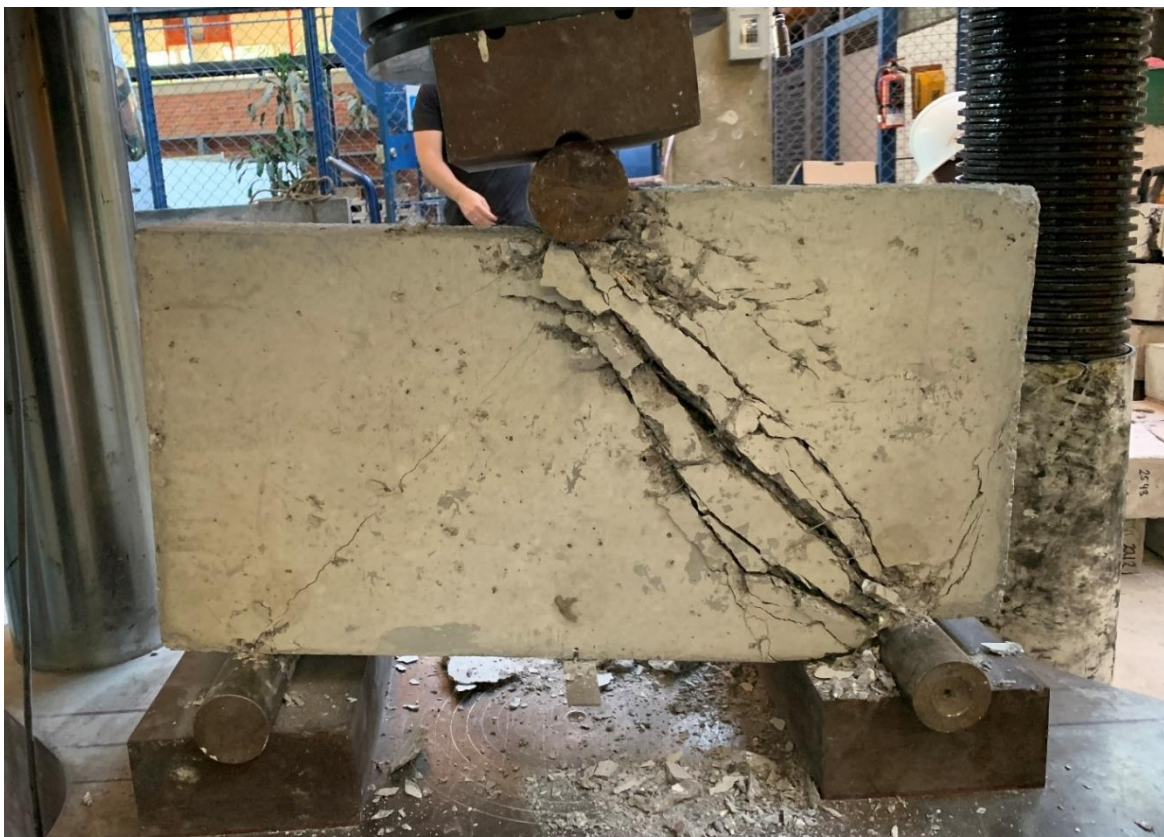
Figura 4. 152. – Viga V2-2543 después de llevarla a la falla con vista posterior.
