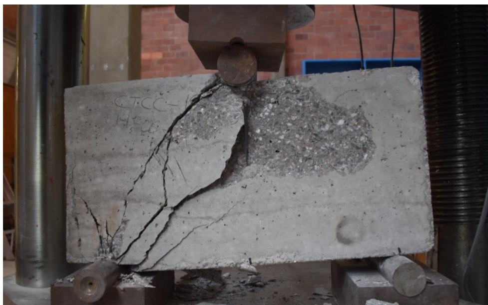
Figura 4. 72. - Viga V1-1858 después de llevarla a la falla vista de frente.
