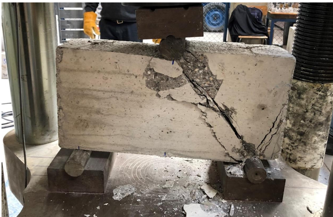
Figura 4. 109. - Viga V2-2230 después de llevarla a la falla con vista posterior. Foto tomada por Bibian I. Silva.
