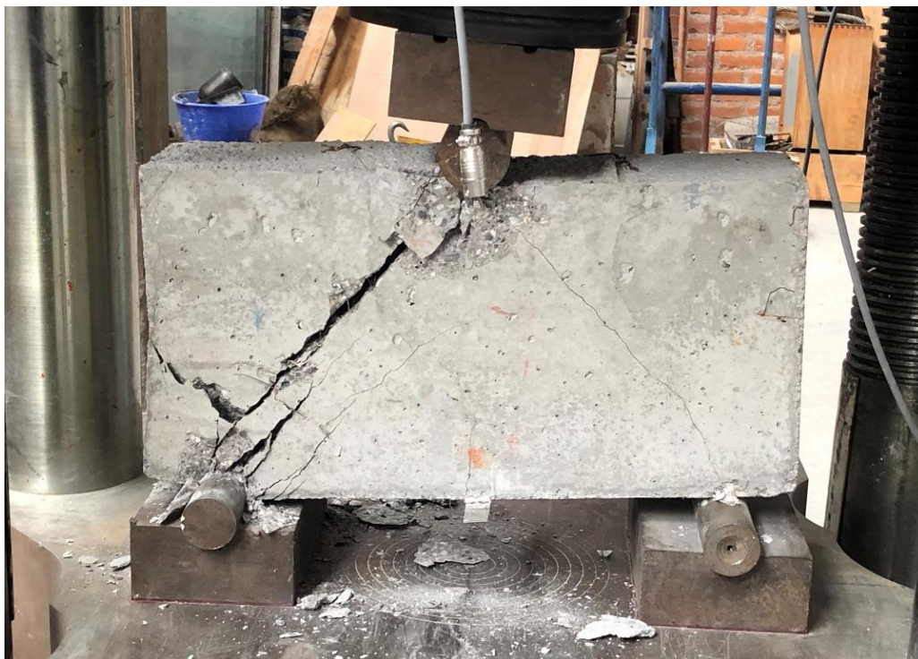
Figura 4. 52. - Viga V3-1709 después de llevarla a la falla vista de frente.
