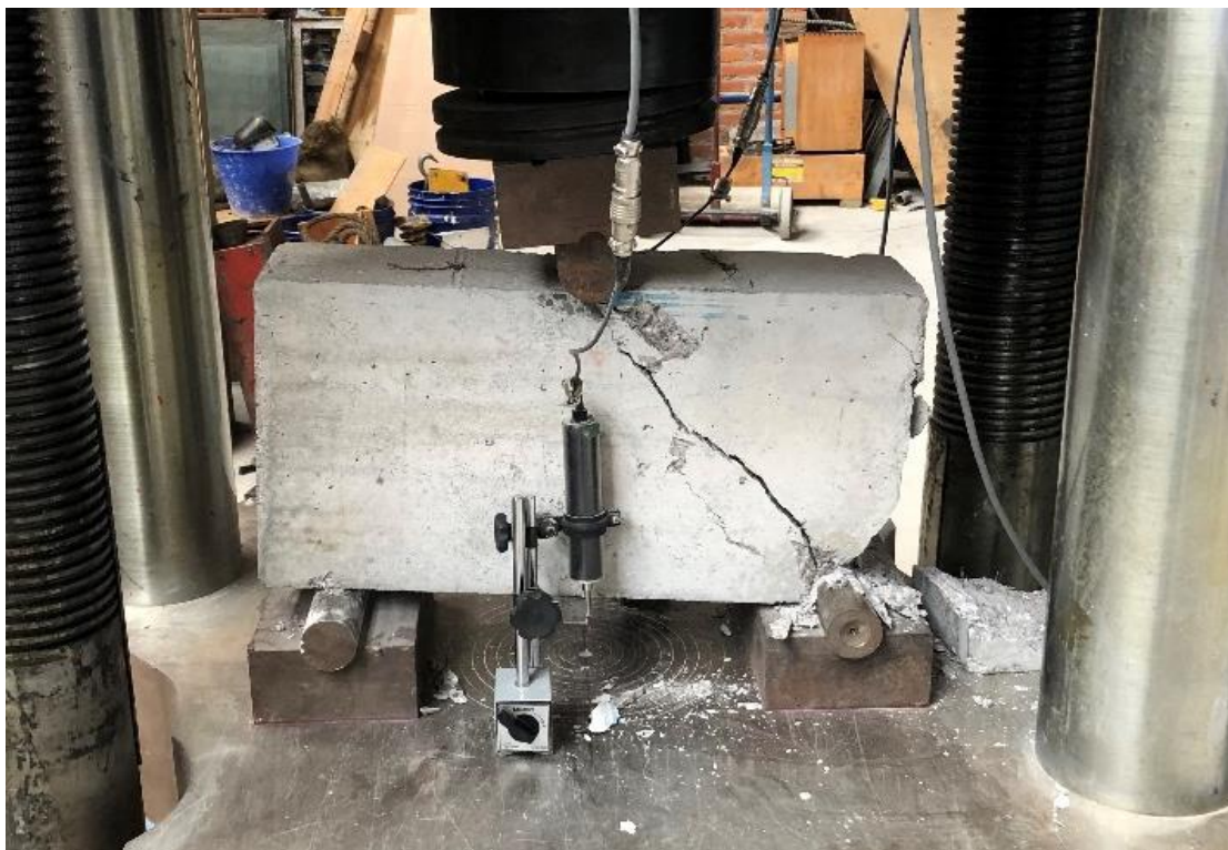
Figura 4. 57. - Viga V1-1787 después de llevarla a la falla vista de frente.
