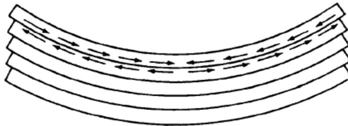
Figura 1. 3. - Arreglo de tablones horizontales flexionados por una fuerza central, donde esquemáticamente se muestra la fricción en la superficie de los tablones con flechas (Méndez, 2017).
