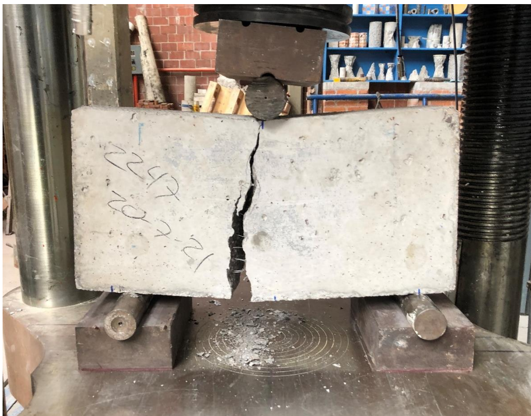
Figura 4. 126. – Viga V3-2247 después de llevarla a la falla con vista frontal. Foto tomada por Bibian I. Silva.
