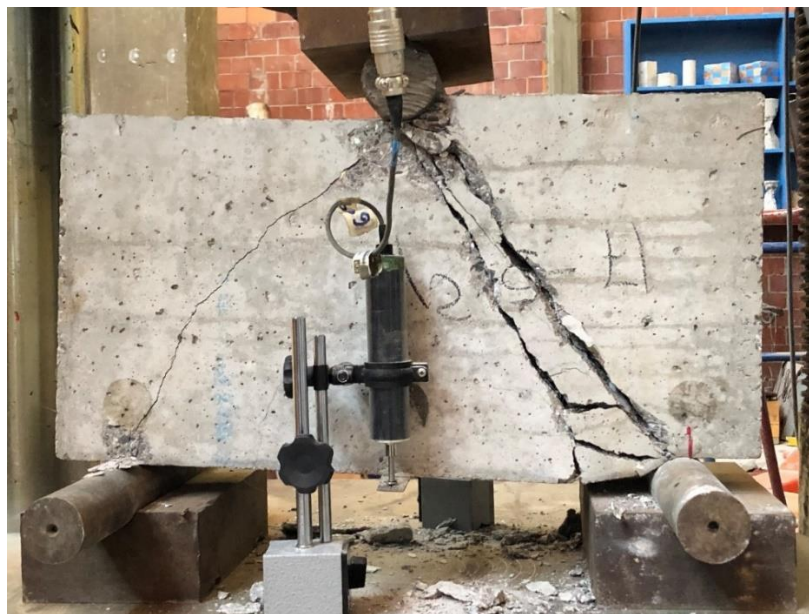
Figura 4. 26. - Viga V1-1571 después de llevarla a la falla en vista frontal. Foto tomada por Bibian I. Silva.
