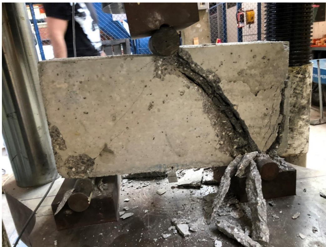
Figura 4. 73. - Viga V1-1858 después de llevarla a la falla con vista posterior. Foto de Bibian I. Silva.
