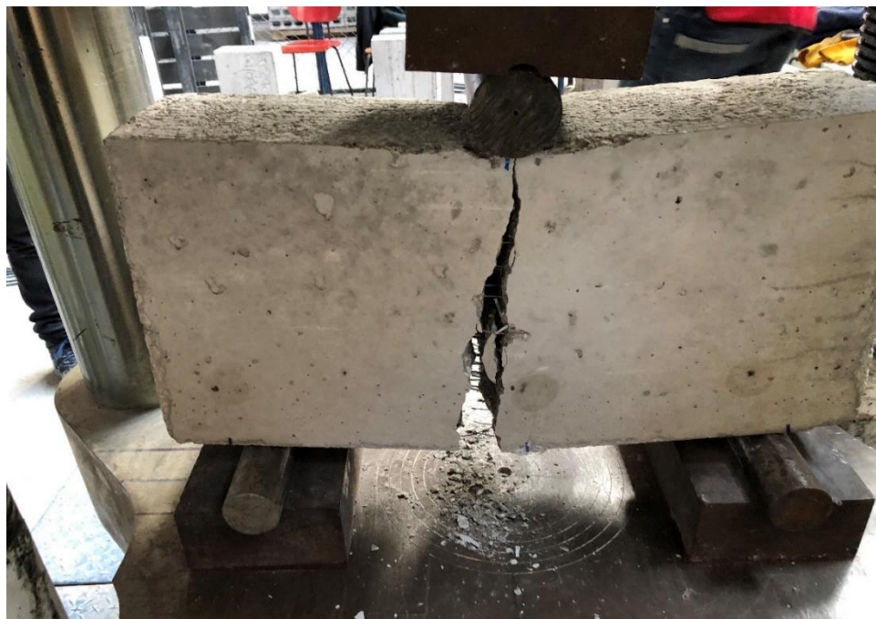
Figura 4. 123. - Viga V1-2247 después de llevarla a la falla con vista posterior. Foto tomada por Bibian
