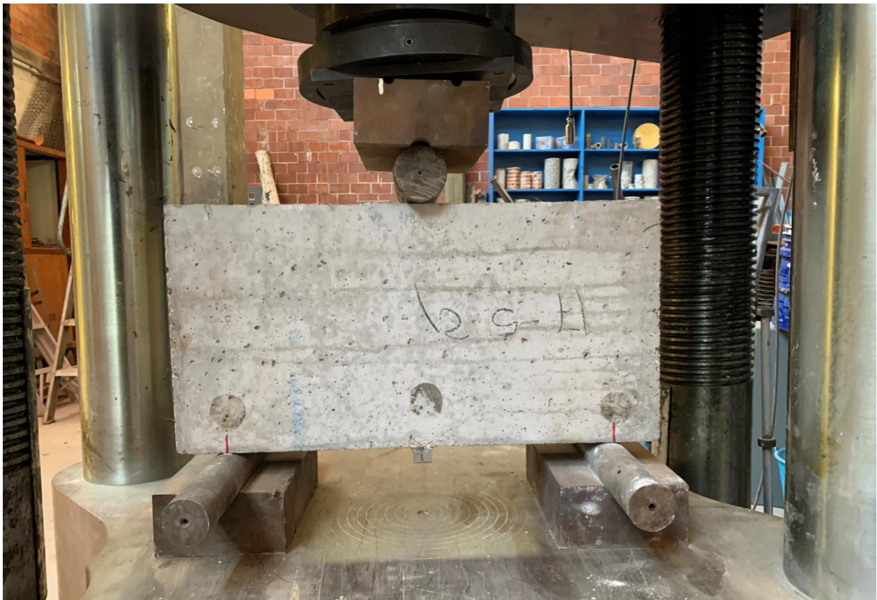
Figura 4. 5. - Espécimen 1539-1 con arreglo para falla a cortante.
