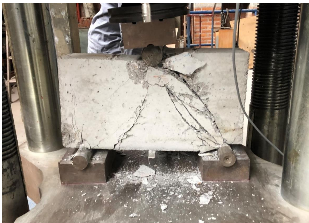
Figura 4. 60. - Viga V2-1787 después de llevarla a la falla vista de frente.
