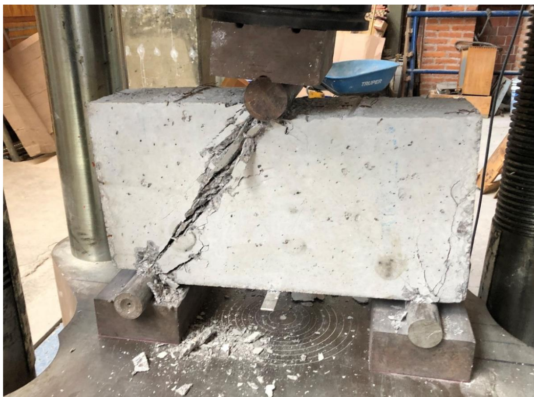
Figura 4. 93. - Viga V1-2102 después de llevarla a la falla vista de frente. Foto tomada por Bibian I. Silva.
