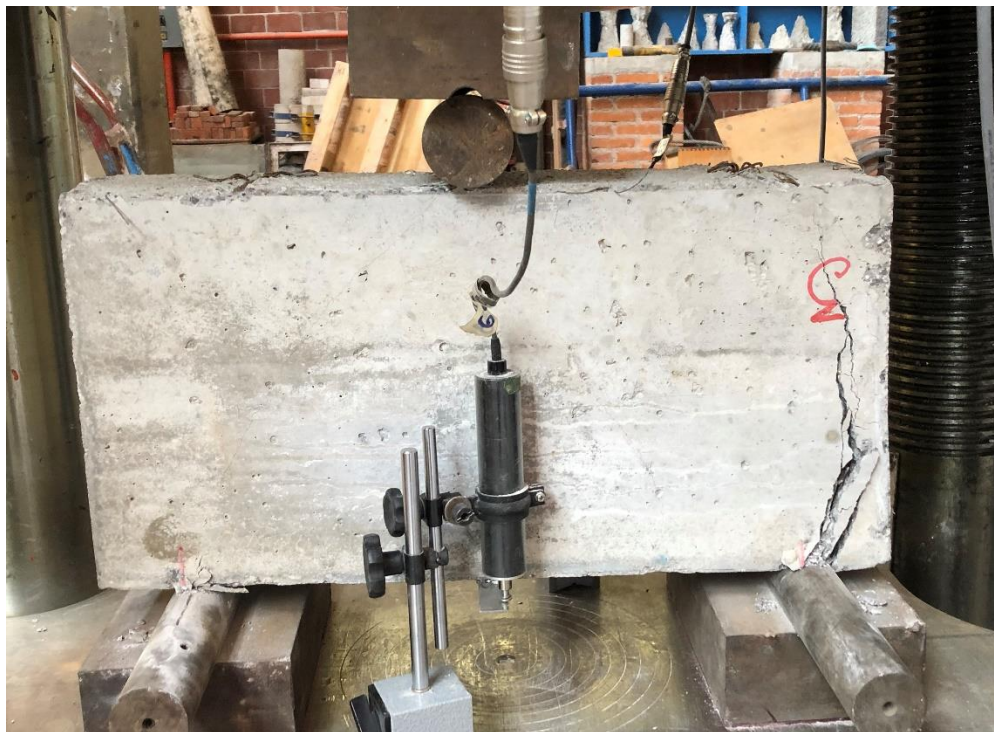
Figura 4. 38. - Viga V3-1610 después de llevarla a la falla en vista frontal. Foto tomada por Bibian I. Silva.
