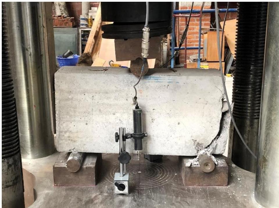
Figura 4. 55. - Primer agrietamiento de viga V1-1787.
