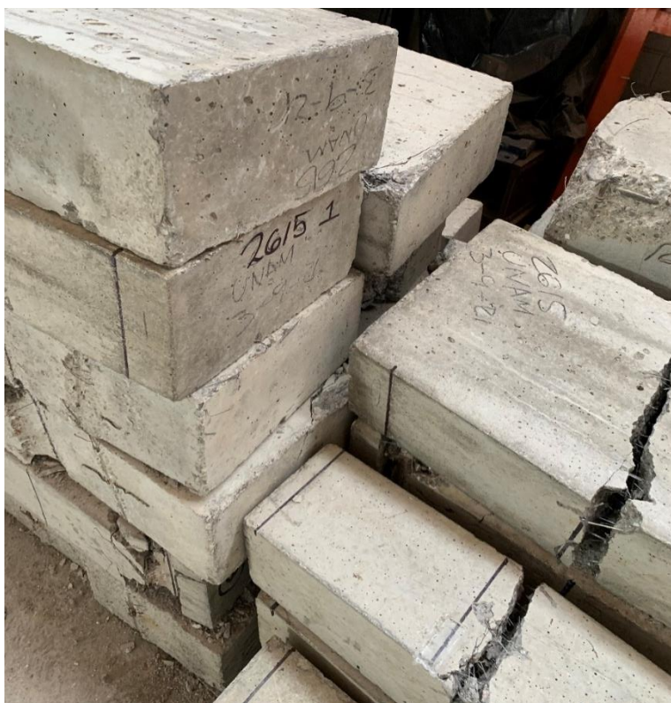
Figura 4. 167. – Vigas de la serie 2615 apiladas donde se ve la falla en el centro.
