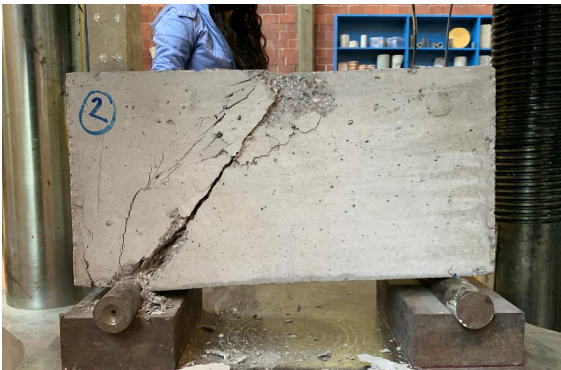
Figura 4. 43. - Viga V2-1690 después de llevarla a la falla vista de frente.
