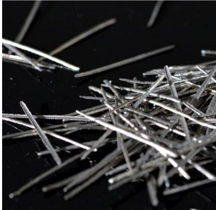
Figura 2. 1. - Fibras de acero inoxidable rectas (Dalian HARVEST Metal Fibres Co., 2022)
