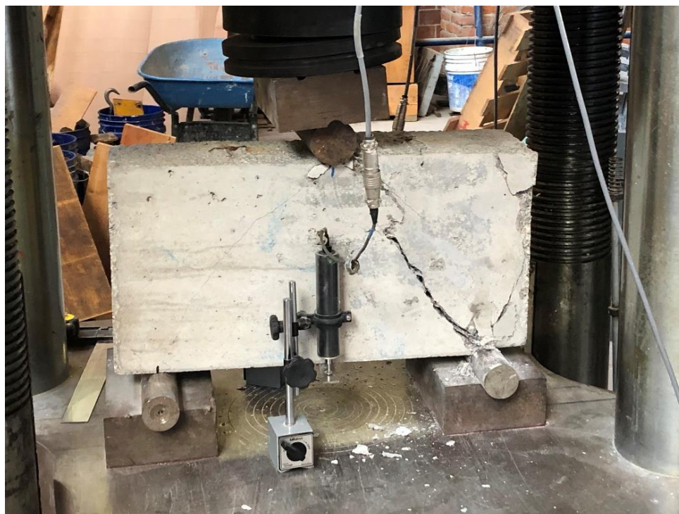
Figura 4. 81. - Viga V2-1979 después de llevarla a la falla vista de frente.
