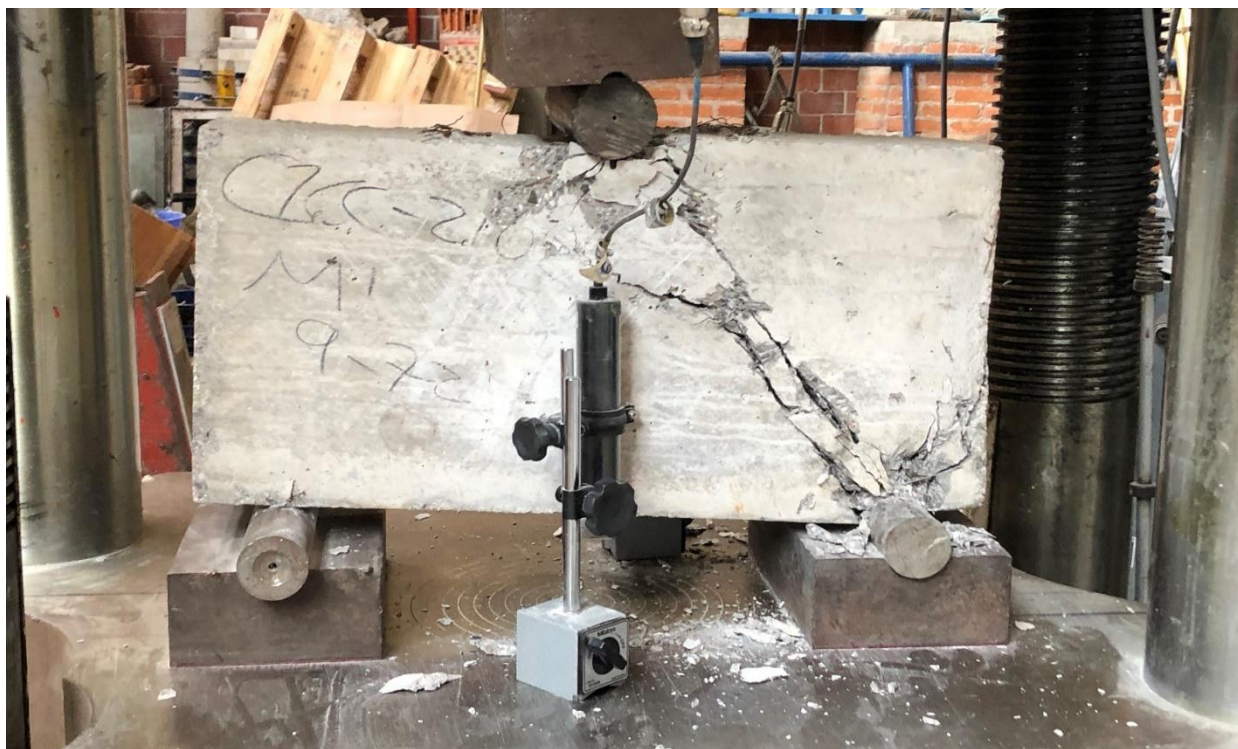
Figura 4. 97. - Viga V2-2102 después de llevarla a la falla vista de frente. Foto tomada por Bibian I. Silva.
