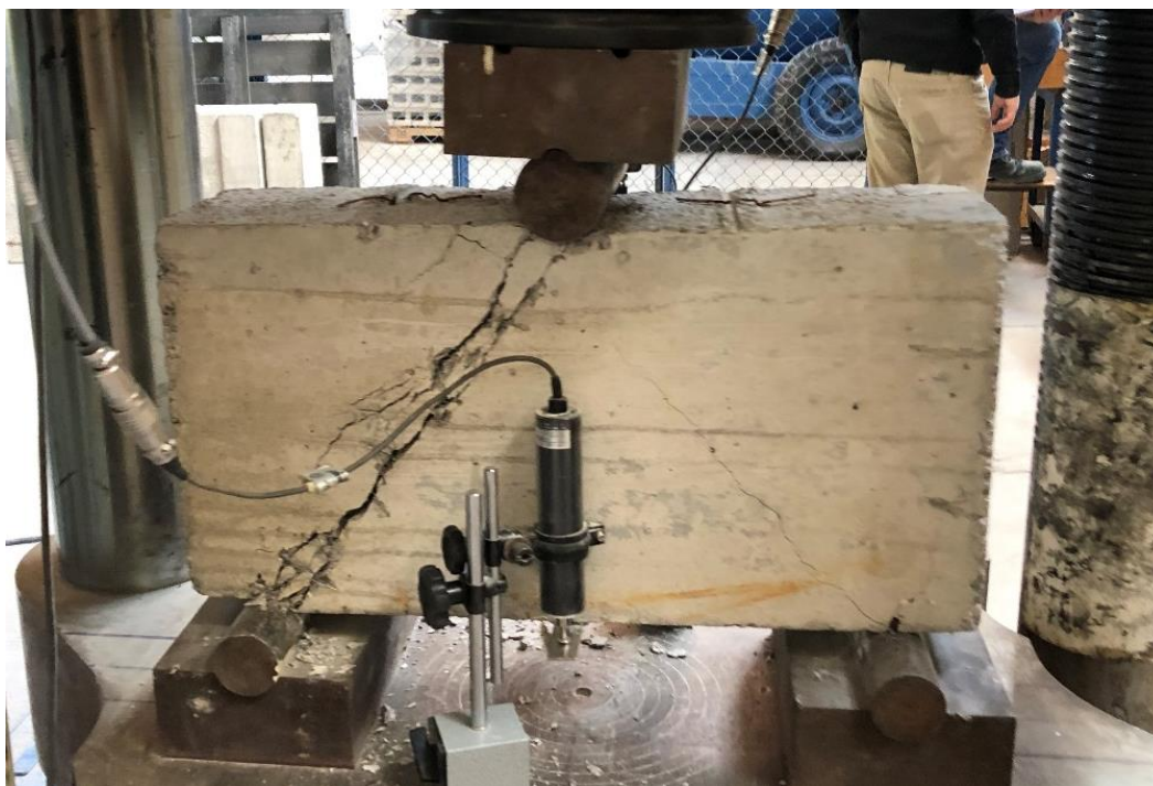
Figura 4. 88. - Viga V2-1996 después de llevarla a la falla con vista posterior. Foto tomada por Bibian I. Silva.
