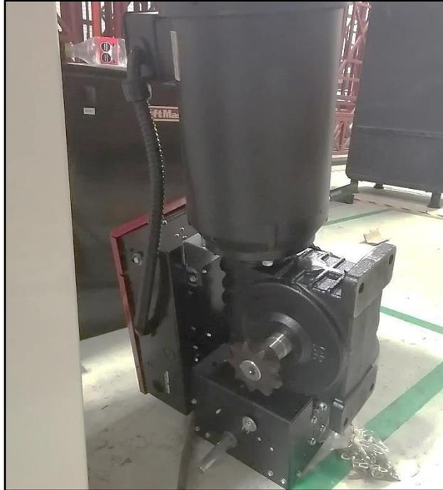
Figura 44. Abridor gearhead GH303 L5 con sprocket por defecto montado en el eje de salida
