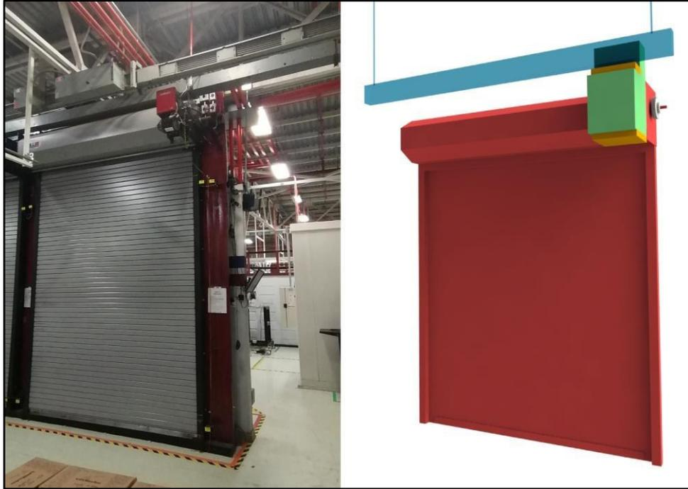
Figura 43. Vista frontal de puerta enrollable: modelo en el laboratorio y modelo diseñado en CAD
