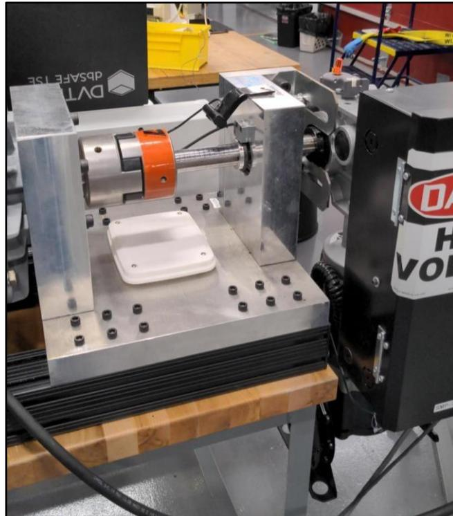
Figura 34. Base butcher actual con todos los soportes y accesorios montados
