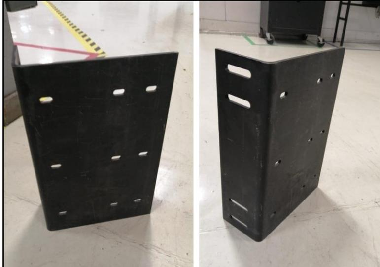
Figura 18. Bracket de montaje del abridor GH101<sup>®</sup> actual
