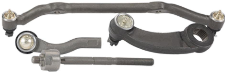
Imagen 3.1. Terminales de dirección (*Inner - Tie Rod End*) [1]
