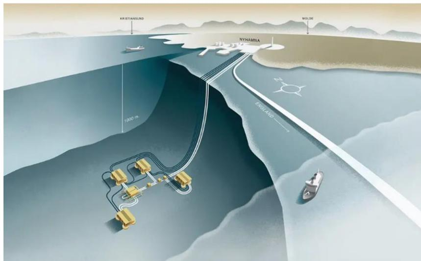
*Figura 2. Esquema de producción del campo Ormen Lange
