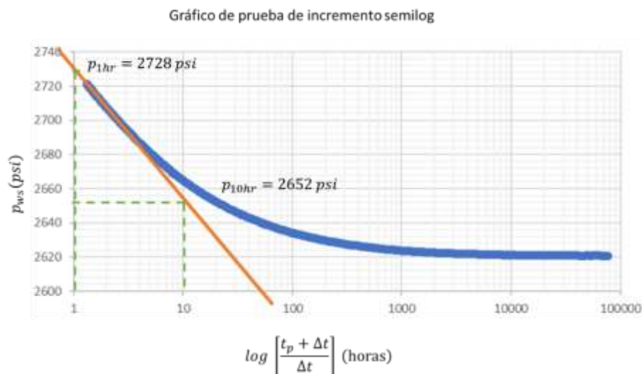
Figura 114 Gráfico semilogarítmico de presión vs tiempo de Horner de la pendiente para ejercicio (Elaboración propia).
