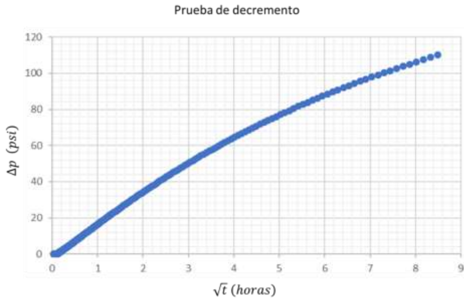
Figura 110 Prueba de decremento de presión, \Delta p vs \sqrt{t} (Elaboración propia).
