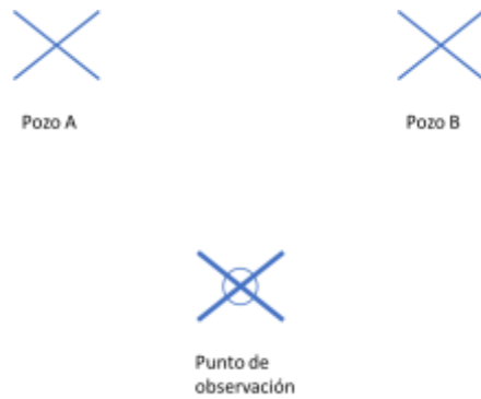
Figura 14 Distribución ideal de los pozos para una prueba de interferencia caída de presión, \Delta p en el punto de observación es igual a la suma de \Delta p_A y de \Delta p_B , donde el punto de observación puede estar ubicado en cualquier parte del yacimiento ( Elaboración propia ).
