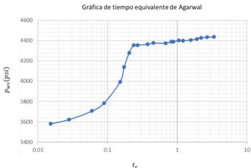
Figura 62 Gráfico semilog del comportamiento de una prueba de incremento por el método de tiempo equivalente de Agarwal de p_{ws} vs t_e (Elaboración propia).
