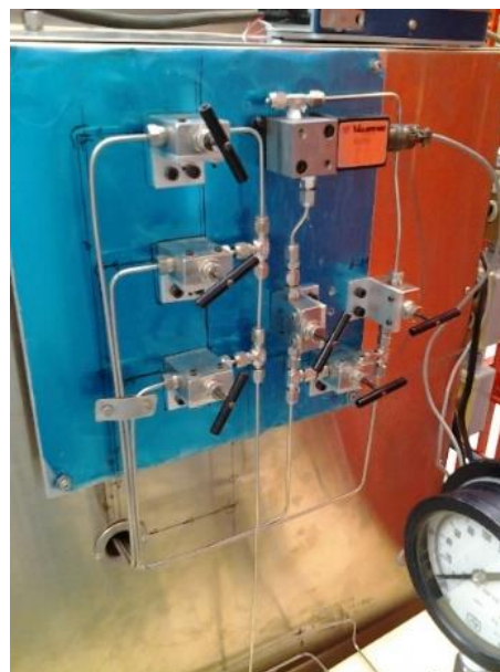
Figura 39 Válvulas de salida
