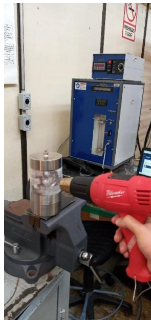
Figura 60 Ajuste de la manga termo ajustable sobre el núcleo de roca A
