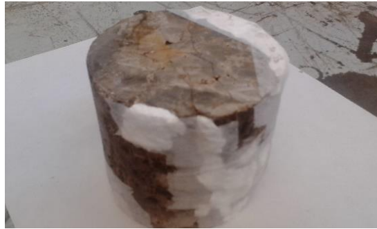
Figura 9 Roca seca y rellena
