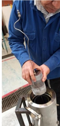
Figura 63 Colocación del núcleo y manga al interior de la celda porta núcleos
