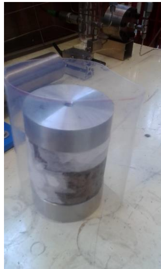
Figura 12 Roca con dispersores y manga termo ajustable
