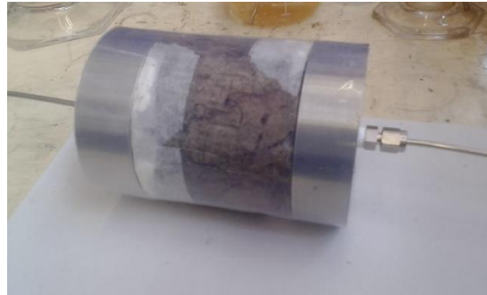
Figura 61 Núcleo de roca con dispersores y líneas de entrada y de salida
