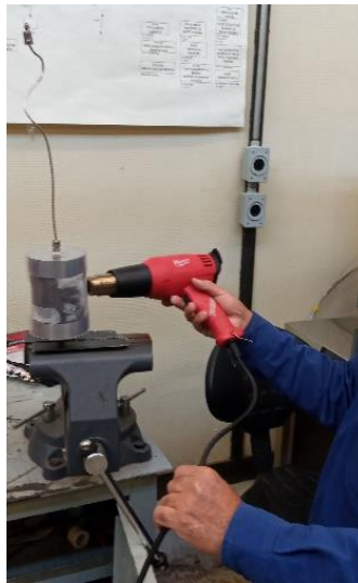
Figura 13 Ajuste de la manga termo ajustable con pistola de calor
