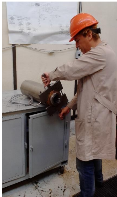
Figura 64 Enroscado y apriete de las tapas de la celda porta núcleos
