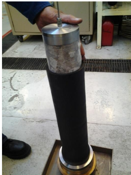
Figura 62 Colocación del núcleo A al interior de la manga de vitón
