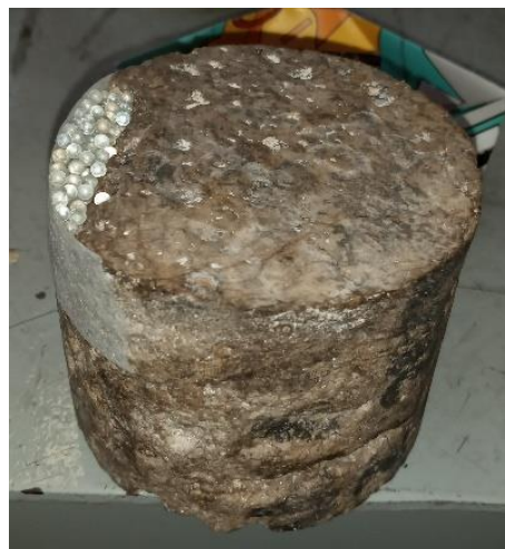
Figura 8 Relleno de la roca con perlas de vidrio
