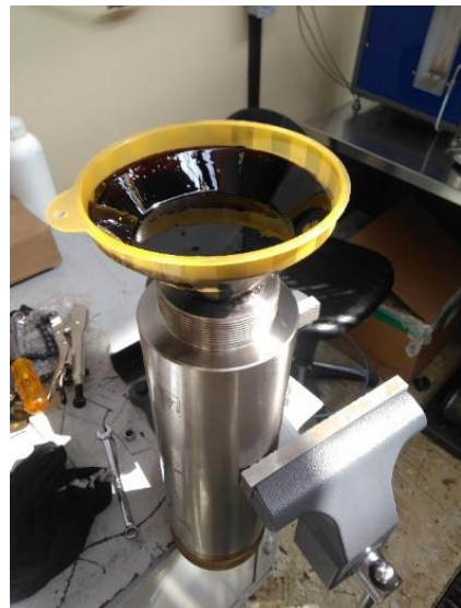
Figura 67 Llenado de cilindro de transferencia con aceite muerto
