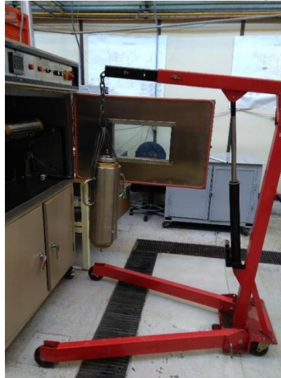
Figura 65 Colocación del core holder en el interior del horno empleando una grúa
