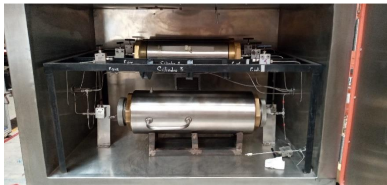
Figura 17 Detalle del interior del equipo permeámetro
