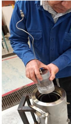
Figura 14 Colocación de la roca A en el core holder
