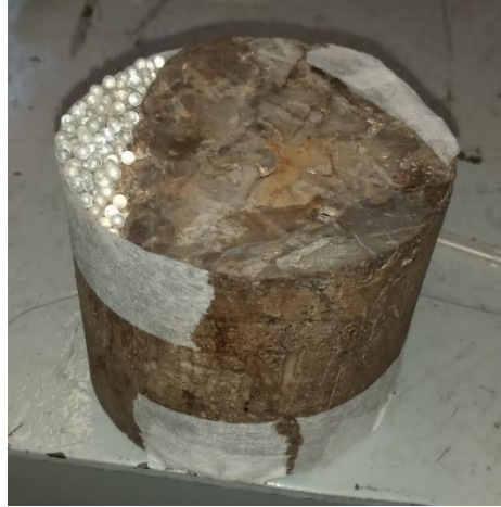
Figura 57 Núcleo de roca durante el proceso de relleno
