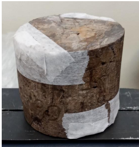
Figura 58 Núcleo de roca A relleno con perlas de vidrio
