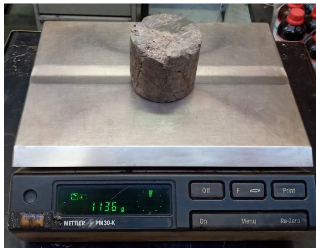
Figura 56 Peso del núcleo de roca limpio, seco y sin relleno
