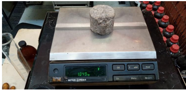
Figura 7 Peso de la roca limpia y seca
